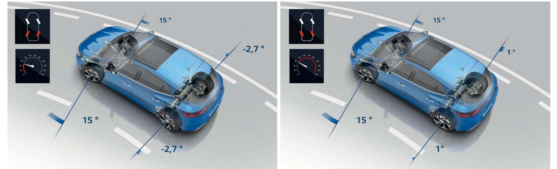
À basse vitesse, le système 4CONTROL braque les roues arrière dans le sens inverse des roues avant. Au-delà de 80km/h\*, les roues arrière braquent dans le même sens que les roues avant.
