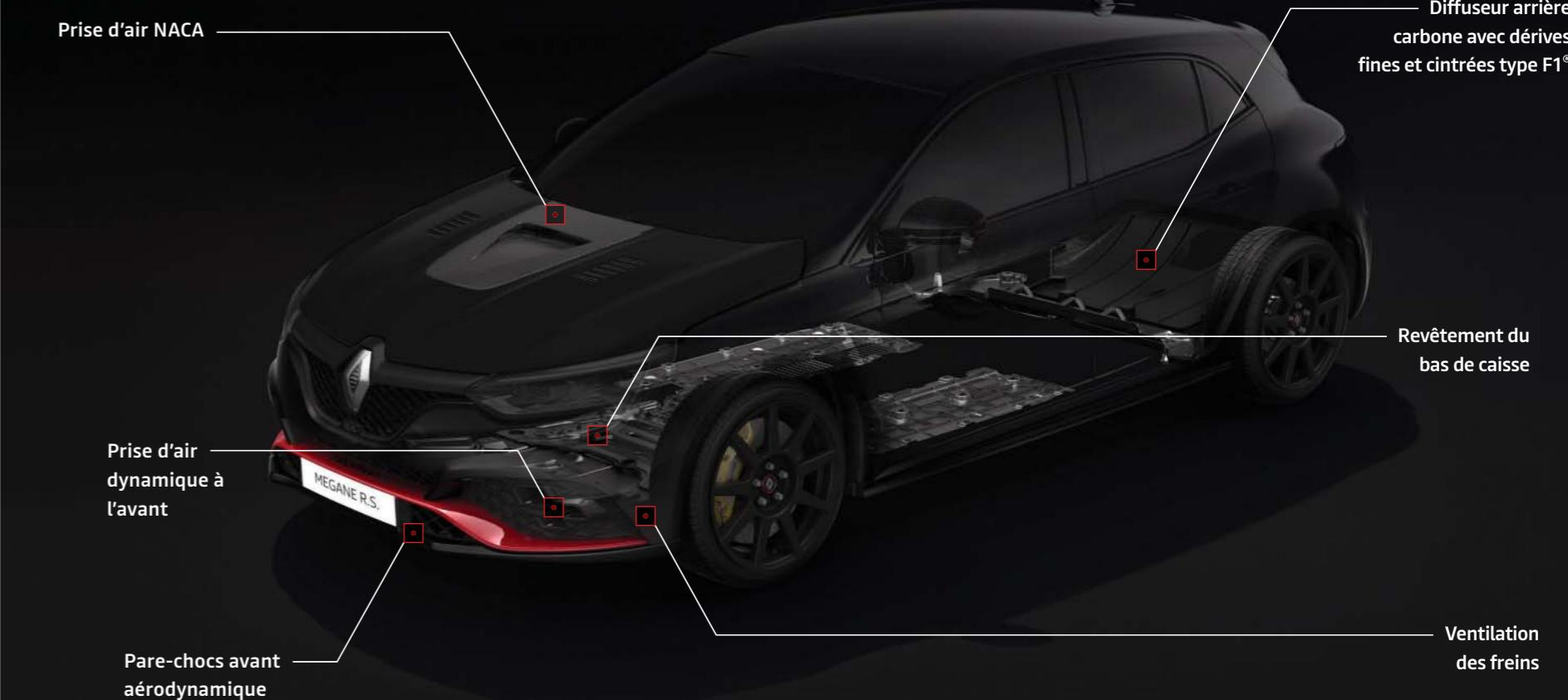
Sur le pare-chocs avant, une petite prise d'air garantit davantage de stabilité alors que le revêtement sous le moteur permet un écoulement d'air continu sous le véhicule.
