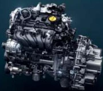
1.8-Liter-Triebwerk mit Direkteinspritzung und Turbolader, Leistung: 300 PS
