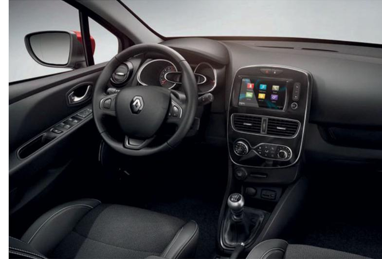
Abbildung mit optionalem R-LINK Evolution und Schalthebel des 6-Gang-Schaltgetriebes
