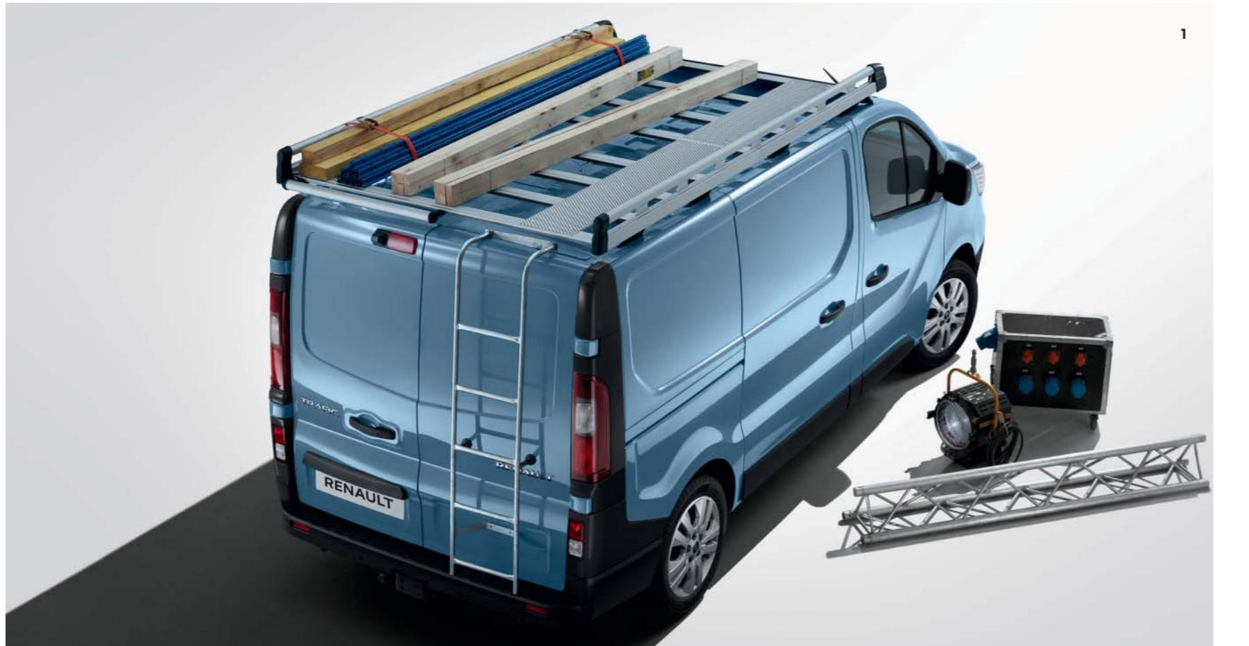
**1. Portapacchi da tetto, passerella e scala.** Equipaggiate il vostro nuovo Renault Trafic con il portapacchi da tetto in alluminio in grado di trasportare quasi 150 kg. Completo di una passerella e di una scala, diventerà un bene indispensabile per tutti i vostri spostamenti.
