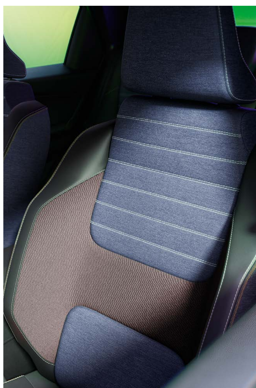
sellerie textile mixte 100% recyclé, textile jean avec double surpiqûre grise/textile central ocre/textile refined recyclé noir
