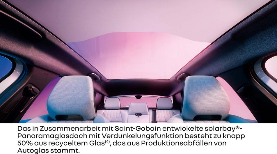
Das in Zusammenarbeit mit Saint-Gobain entwickelte solarbay<sup>®</sup>-Panoramaglasdach mit Verdunkelungsfunktion besteht zu knapp 50% aus recyceltem Glas<sup>(4)</sup>, das aus Produktionsabfällen von Autoglas stammt.
