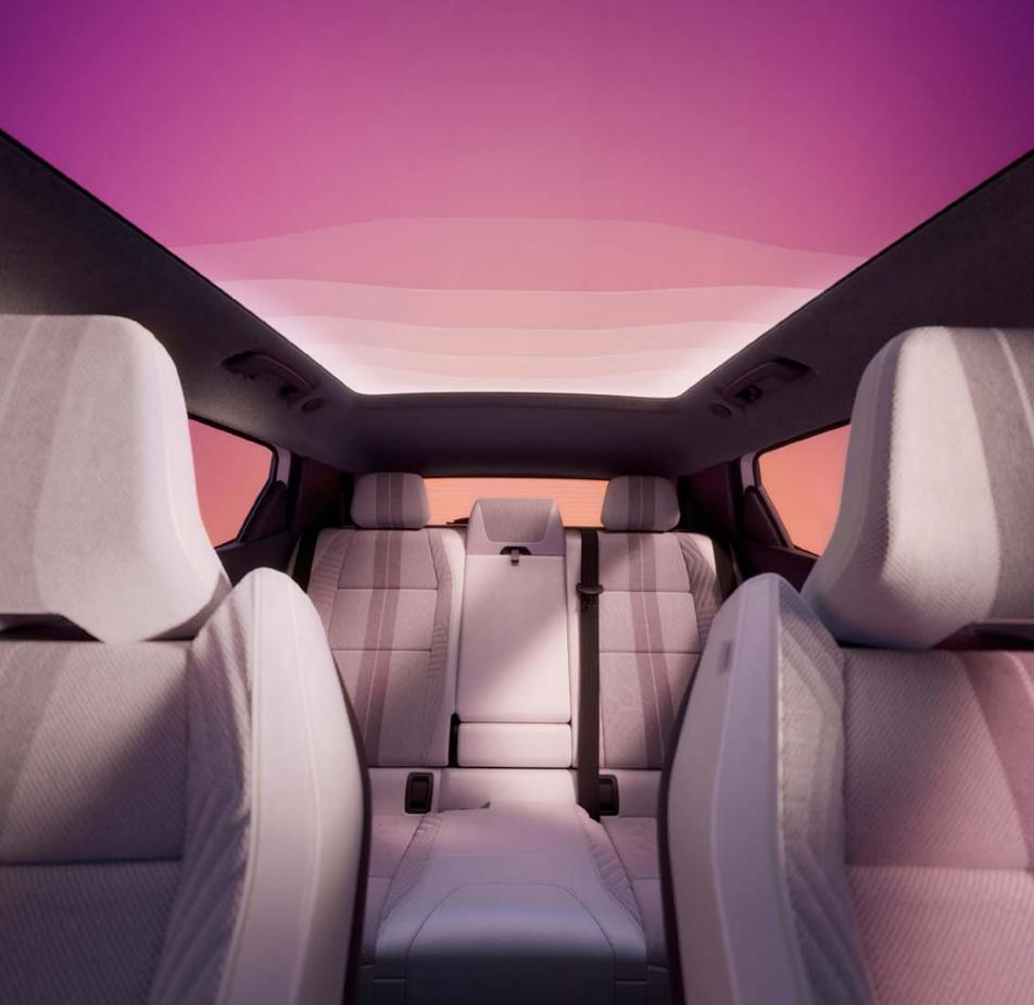
Die SolarBay®-Technologie lässt sich per Sprachsteuerung via Google Assistant<sup>(3)</sup> oder manuell über einen Schalter im Dachhimmel bedienen. Es stehen 4 Verdunkelungsstufen zur Auswahl, sodass sowohl im Sommer als auch im Winter die Helligkeit und der Klimakomfort an Bord gewährleistet sind. Das System bewahrt die Reichweite der Batterie, indem es den Verbrauch für die Klimaanlage oder die Heizung reduziert.
