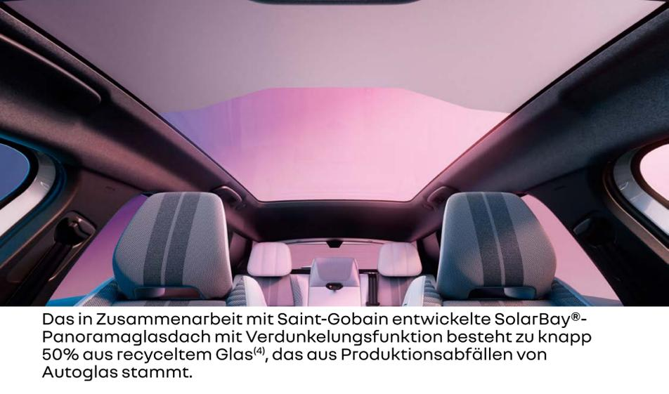
Das in Zusammenarbeit mit Saint-Gobain entwickelte SolarBay®-Panoramaglasdach mit Verdunkelungsfunktion besteht zu knapp 50% aus recyceltem Glas<sup>(4)</sup>, das aus Produktionsabfällen von Autoglas stammt.
