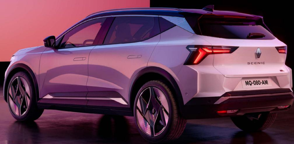
Sa plateforme accueille une batterie de 87 kWh et un moteur électrique efficient de 220 ch pour une autonomie allant jusqu'à 625 km<sup>(1)</sup> selon WLTP.
