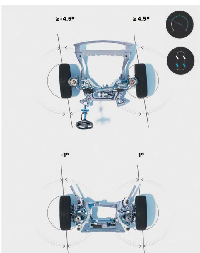
bei über 50 km/h weisen die Hinterräder die gleiche Richtung wie die Vorderräder auf, um die Strassenlage und die Sicherheit zu verbessern
