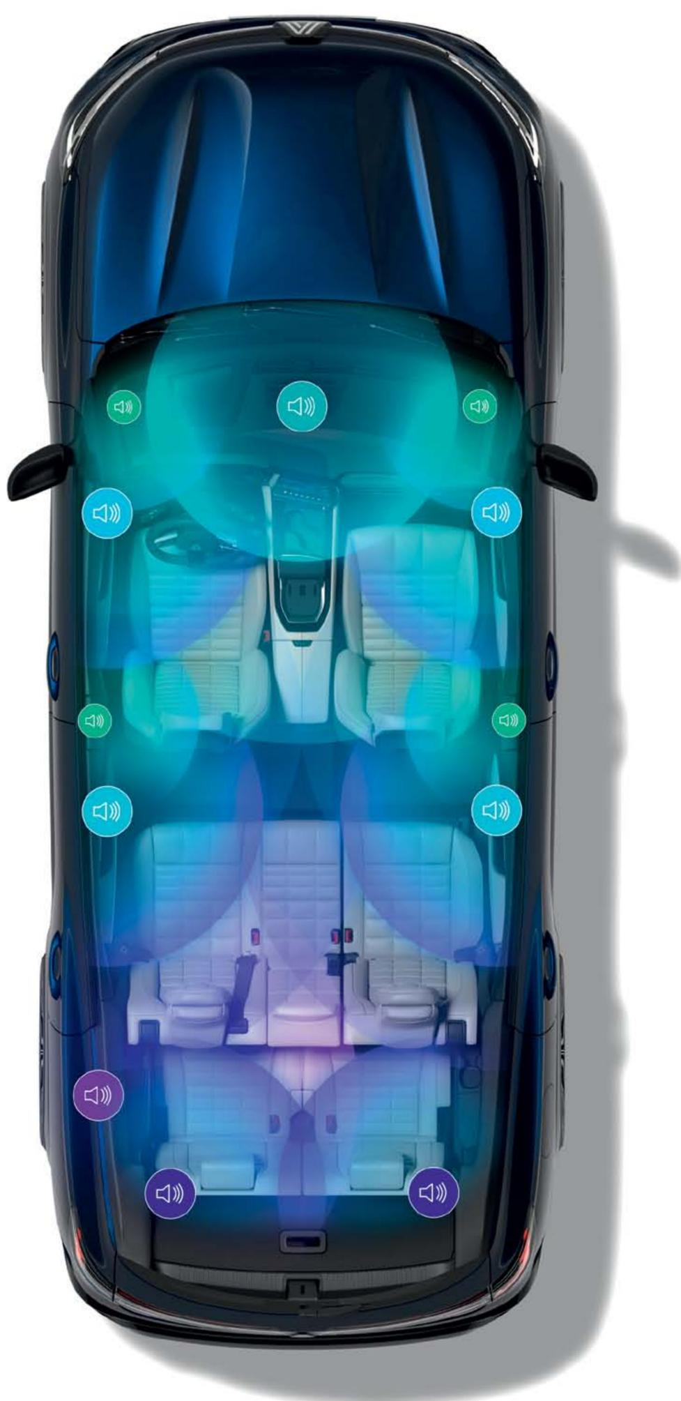
je 1 Hochtöner auf beiden Seiten des Armaturenbretts, je 1 Tieftöner in den beiden Türverkleidungen vorne und je 1 Tieftöner in den beiden Türverkleidungen hinten, 2 Surround-Lautsprecher, 1 zentrale Einheit vorne, 2 Hochtöner und 1 Subwoofer im Kofferraum
