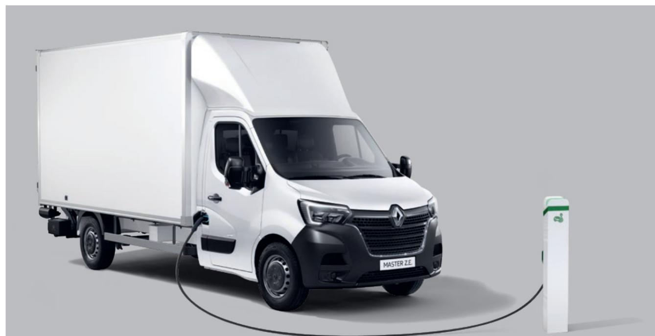
La nouvelle version châssis-cabine est disponible en longueur L2 et L3, en hauteur H1, avec une charge utile de 1 620 kg maximum avant transformation. Ce Master Z.E. châssis-cabine permet une très large palette de transformations, notamment en grand volume, idéal pour la livraison urbaine.
