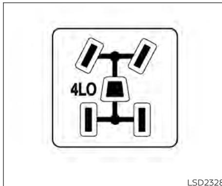
Luz indicadora de cambio 4WD (Tracción en las cuatro ruedas)
