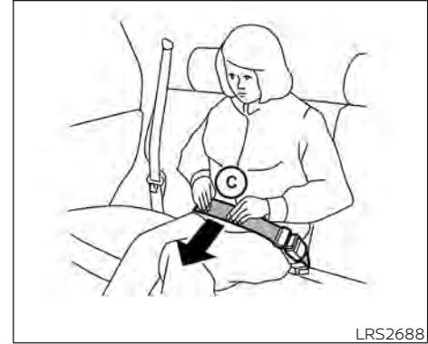
3. Coloque el cinturón de cadera **bajo y ajustado en las caderas (C)**, como se muestra.
