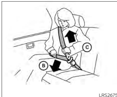
3. Coloque la parte del cinturón pélvico en una posición **baja y ajustada en las caderas (B)**, como se muestra.
