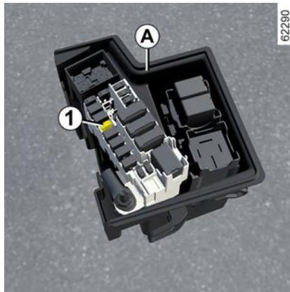
**Fusible de LPG** en el compartimento del motor **A**.
