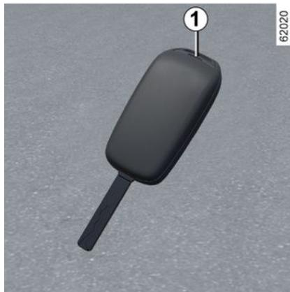
Abra la caja por la hendidura **1** con un destornillador plano o una herramienta similar y sustituya la pila **2** respetando el modelo y la polaridad que se muestran en el fondo de la tapa.
