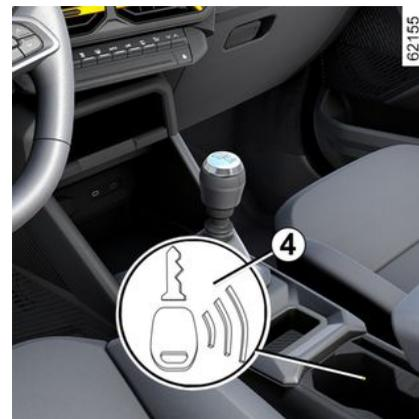
Pise el pedal del freno o del embrague y, a continuación, coloque la tarjeta **3** encima del símbolo **4**. Presione el botón **1** para arrancar el vehículo. El mensaje se apaga.
