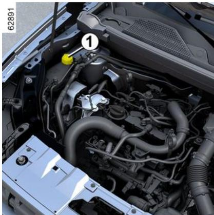
Con el motor apagado y el vehículo sobre una superficie plana, el nivel **en frío** debe estar situado entre las marcas "**MINI**" y "**MAXI**" del depósito de refrigerante **1**.
