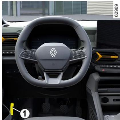
En función del vehículo, tire de la palanca **1** para abrir.
