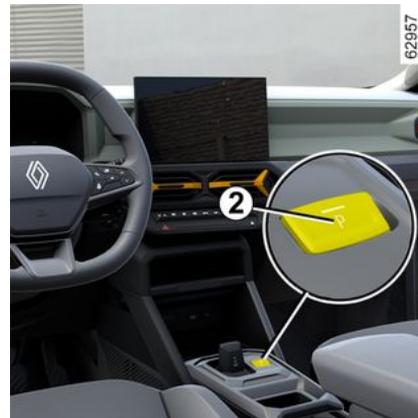
Con el vehículo detenido y el motor en marcha o el contacto puesto, presionar el botón **2** para seleccionar la posición **P**. El testigo del botón **2** se ilumina en naranja cada vez que se seleccione la posición **P** de Aparcamiento.
