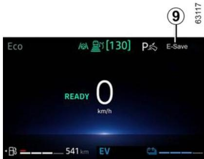
El testigo **9** aparece en el cuadro de instrumentos para confirmar la activación.
