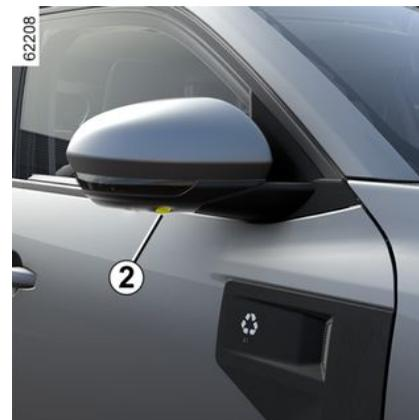
Las cámaras **2** incorporadas en los retrovisores exteriores transmiten las vistas laterales a la pantalla **4**.
