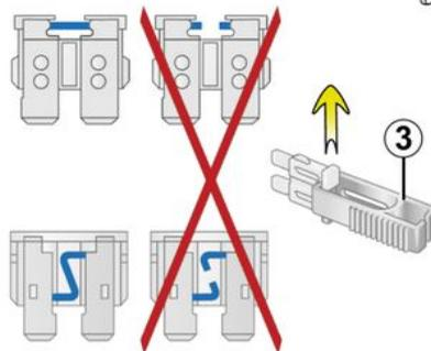
Suelte el fusible con las pinzas **3**, situadas en la parte trasera de la tapa **A** o **B**.
