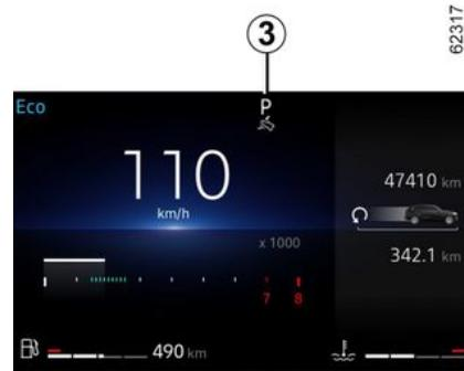
La pantalla **3** situada en el cuadro de instrumentos le informa de la posición de la palanca de velocidades seleccionada **1**.
