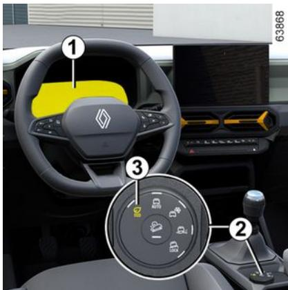
Para activar este modo, gire el selector **2** hasta la posición "ECO" **3**: la luz integrada en el selector se enciende
