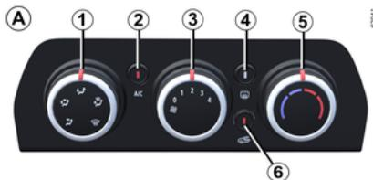
El botón **6** sirve para activar (testigo encendido) o desactivar (testigo apagado) el aislamiento del habitáculo / la función de recirculación de aire.
