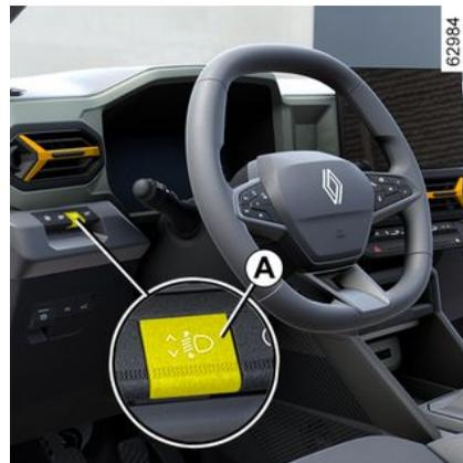
El botón **A** permite corregir la altura de las luces de carretera en función de la carga.
