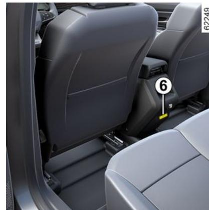
Los puertos multimedia USB-C **2** y **6** pueden utilizarse para cargar accesorios con una potencia máxima de 12 vatios (5 voltios) por toma.
