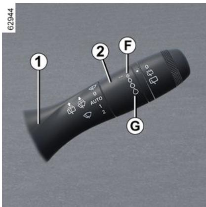
Es posible modificar el valor de activación y el intervalo entre barridos mediante el giro del anillo **2**:
