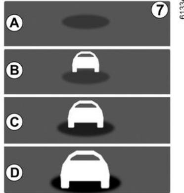
Con la función activada, se muestra el indicador **7** en el cuadro de instrumentos para informar al conductor de la distancia entre su vehículo y el de delante:
