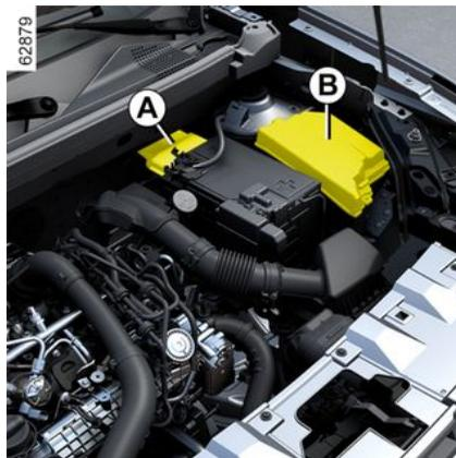
Algunas funciones están protegidas por fusibles situados en el compartimento del motor, en los módulos **A** y **B**.
