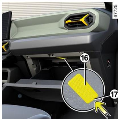
Soltar la luz **16** con un destornillador plano o un útil similar, presionando la pestaña **17** para mover la luz hacia el interior de la guantera.
