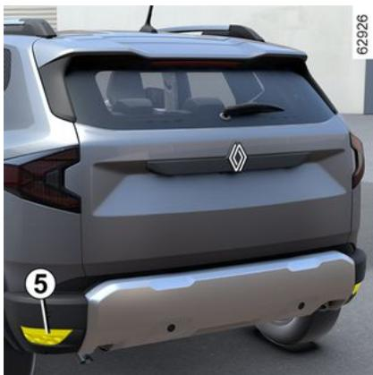
Acceda al portalámparas situado debajo del parachoques trasero y, a continuación, aflójelo girando hacia el centro del vehículo y retire la bombilla.
