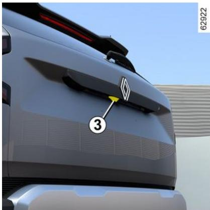
Si la cámara trasera se activa automática o manualmente, la vista de la cámara aparece en la pantalla 4.
