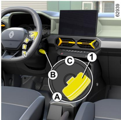
Para bloquearla, retire la llave **1** y gire el volante hasta que se bloquee la columna de dirección.
