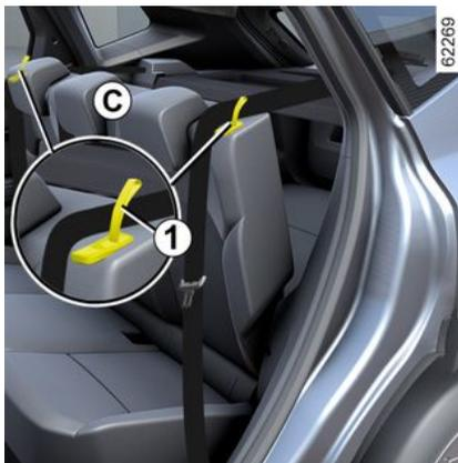
Según el vehículo, para desbloquear la banqueta **C**, tire simultáneamente de las lengüetas **1** para desbloquearla desde el interior.
