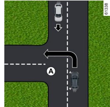
En caso de que se desee efectuar un cambio de dirección (por ejemplo, **A**), el sistema detecta los vehículos que se aproximan cuando:
