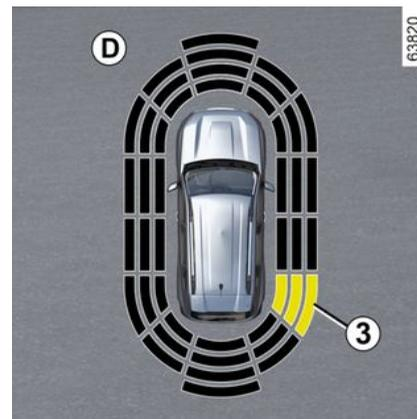
Según la orientación de las ruedas, el sistema determina la trayectoria del vehículo y notifica al conductor si hay riesgo de colisión o de no coli-
