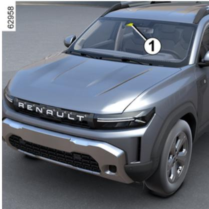
Utilizando la información de la cámara **1**, la función activa una corrección en el sistema de dirección del vehículo cuando se cruza una línea continua o discontinua, o al acercarse a borde de la carretera (mediana, barrera, talud, terraplén, etc.) sin que
