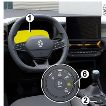
Para activar este modo, gire el selector **2** hasta la posición **"MUD-SAND" 6**: la luz integrada en el selector se enciende y se muestra **"MUD-SAND"** en el cuadro de instrumentos **1** para confirmar la activación.
