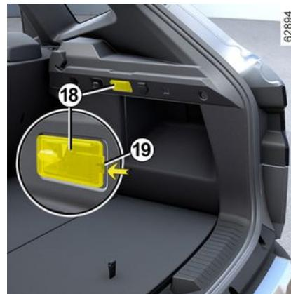
Suelte el iluminador **18** con un destornillador plano o herramienta similar para presionar la lengüeta **19** y bascular el iluminador hacia el interior del maletero.
