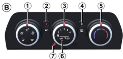
La palanca **7** permite activar y desactivar el aislamiento del compartimento de los pasajeros / la recirculación de aire.
