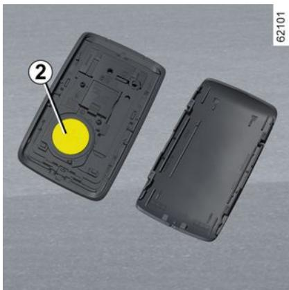
Para volver a colocar la tapa, después proceda en orden inverso y, a continuación, presione cuatro veces uno de los botones de la tarjeta permaneciendo cerca del vehículo: la próxima vez que arranque el vehículo, desaparecerá el mensaje.
