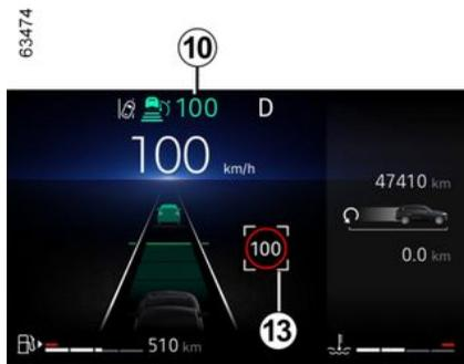
En caso de que el vehículo esté equipado con la función "Reconocimiento de señales de tráfico" → 242, presione el botón 4 para adaptar la velocidad a los límites de velocidad 13 que detecte la cámara.
