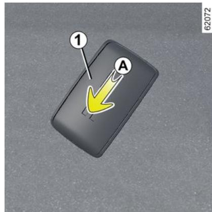
Cuando aparezca el mensaje "Pila de tarjeta casi descargada" en el cuadro de instrumentos, sustituya la pila de la tarjeta:
