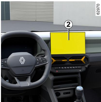
En función del vehículo y con el contacto puesto, es posible activar/desactivar el sistema a través de la pantalla multimedia 2.
