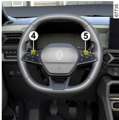
En función del vehículo, las levas **4** y **5** se pueden emplear para cambiar de marcha cuando la palanca **1** se encuentre en la posición **D**.
