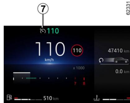
Pulse el interruptor **3** hasta que se encienda la luz **7** en color gris en el panel de instrumentos.
