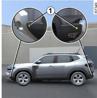
Esta función utiliza captadores **1** instalados en los laterales del parachoques delantero y trasero.
