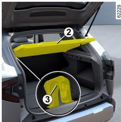
Levante la bandeja **2** a media altura y suelte las fijaciones **3** situadas en cada extremo.
