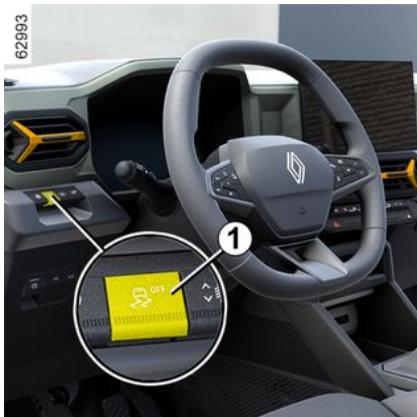
En determinadas situaciones (conducción sobre suelo muy húmedo: nieve, barro, arena, etc. o conducción con cadenas de nieve), el sistema puede reducir la potencia del motor para limitar el patinado de las ruedas. Si no es necesaria, es posible desactivar la función manteniendo pulsado el interruptor 1.
