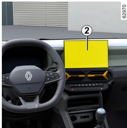
Desde la pantalla multimedia **2**, con la marcha atrás engranada, pulsar el botón "Ajustes" para añadir o suprimir las líneas auxiliares y ajustar la configuración de la imagen de la cámara (brillo, contraste, etc.).
