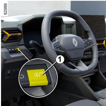
Pulse el interruptor **1** para desactivar la función. Aparece el mensaje "Stop & Start desactivado" en el cuadro de instrumentos y se enciende la luz indicadora del interruptor **1**.
