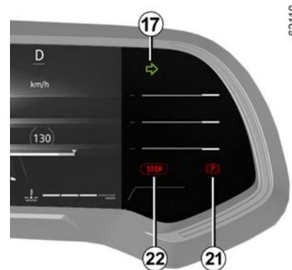
Testigo de freno de aparcamiento o de freno de aparcamiento asistido **21** → 176
