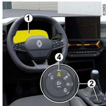
Para activar este modo, gire el selector **2** hasta la posición "AUTO" **4**: la luz integrada en el selector se enciende y se muestra "AUTO" en el cuadro de instrumentos **1** para confirmar la activación.
