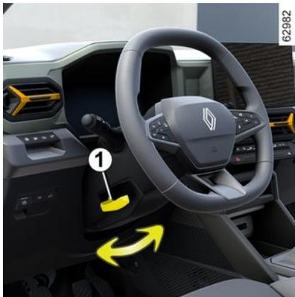
Según el vehículo, se podrán ajustar la altura y la profundidad del volante.
