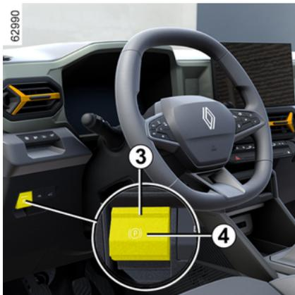
Para activar el freno de aparcamiento asistido de forma manual (en caso de parada en un semáforo en rojo, parada con el motor en marcha, etc.): tirar del interruptor **4** y soltarlo. El freno se desactiva tan pronto el vehículo se arranca de nuevo.
