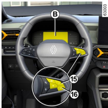
Según el vehículo, utilice el mando **15** o **16** para navegar y seleccionar los distintos widgets del cuadro de instrumentos:
