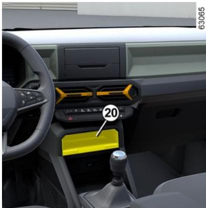
Si su vehículo no está equipado con un sistema de audio, se puede instalar uno y se ha proporcionado el espacio **20** para la radio.
