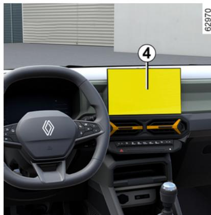
El modo automático se activa cuando se engrana la marcha atrás y la pantalla **4** muestra la vista de la cámara trasera. Cuando se cambia rápidamente de marcha atrás a marcha adelante, la pantalla **4** reproduce la imagen que se transmite desde la cámara frontal.
