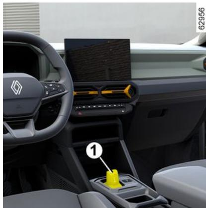
Desplace la palanca de selección **1** una o dos muescas hacia delante o hacia atrás para obtener la posición deseada (**R**, **N**, **D** o **B**) y, a continuación, suelte la palanca que volverá a su posición inicial.
