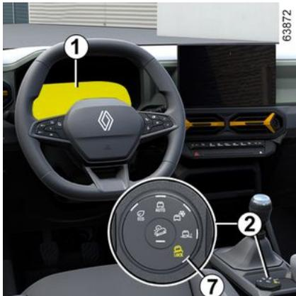
Para activar este modo, gire el selector **2** hasta la posición "OFF-ROAD" **7**. La luz integrada en el selector se enciende y se muestra "OFF-ROAD"
