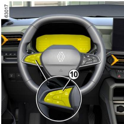
Para adaptar la consigna del limitador de velocidad, del regulador de velocidad o del regulador de velocidad adaptativo Stop and Go al límite de velocidad que se detecte en cada momento, pulse el interruptor **10**.
