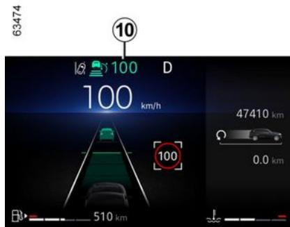
Se puede exceder la velocidad de regulación en cualquier momento pisando el pedal del acelerador.
