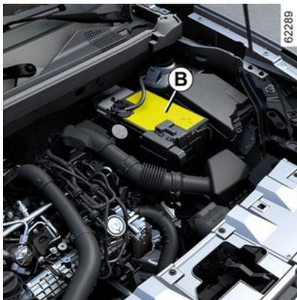
La etiqueta **A** se encuentra en la batería **1**, debajo de la cubierta protectora **B**.
