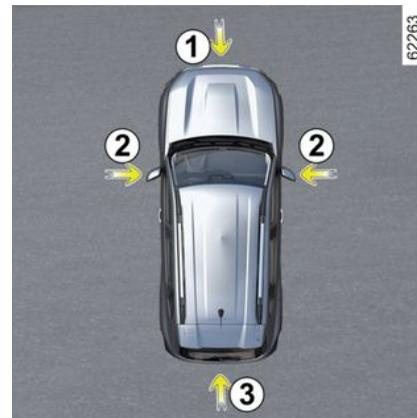
En caso de que estén instaladas en el vehículo, las cuatro cámaras **1**, **2** y **3** ubicadas en el parabrisas delantero, en los retrovisores exteriores y en el portón trasero le facilitan las maniobras difíciles.
