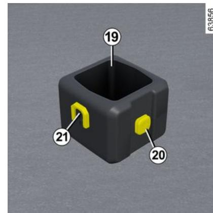
Para instalar la base en vehículos equipados, deslice la base **21** del cubo de arriba hacia abajo en el soporte multiaccesorio **14** o **15**.
