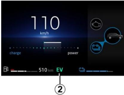
El testigo **2 EV** se muestra en el cuadro de instrumentos para informarle de que el sistema Hybrid está utilizando únicamente el conjunto eléctrico para propulsar el vehículo.
