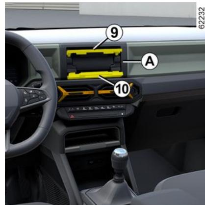
Para los vehículos equipados con ella, abra la trampilla inferior **10**; levante la trampilla **9**; coloque el teléfono **13** en posición horizontal en la bandeja deslizante **12** y luego baje la puerta **9** con el teléfono en la bandeja deslizante **11**.
