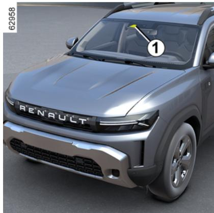
Gracias a la información de la cámara **1**, esta función advierte al conductor del intervalo de tiempo que le separa del vehículo que le precede, para respetar la distancia de seguridad entre ambos.
