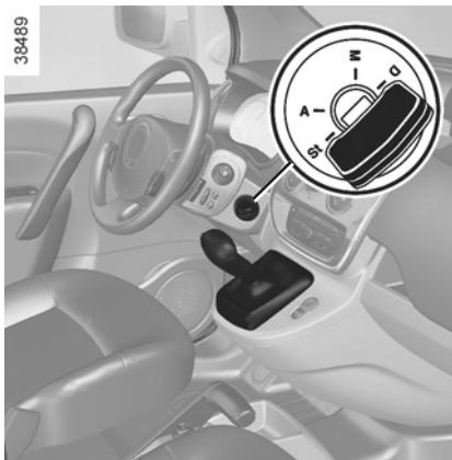
Antes de remolcar, inserte la llave en el contactor para desbloquear la columna de dirección: Gírela hasta la posición **M**.
