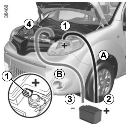
Fije el cable positivo (+) **A** sobre el borne (+) **1** batería descargada, después sobre el borne (+) **2** de la batería que suministre la corriente.
