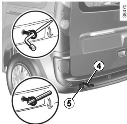
Utilice **exclusivamente los puntos de remolcado delanteros y traseros** (nunca los tubos de transmisión). Estos puntos de remolcado tan sólo se pueden emplear para remolcar, en ningún caso deben servir para levantar directa o indirectamente el vehículo.
