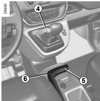
**Al poner el vehículo en marcha**, si la palanca se queda bloqueada en **P** al pisar el pedal de freno, existe la posibilidad de liberarla manualmente. Para ello, suelte la tapa de la base de la palanca y pulse simultáneamente la marca **4** y el botón de desbloqueo **6** situado en la palanca.
