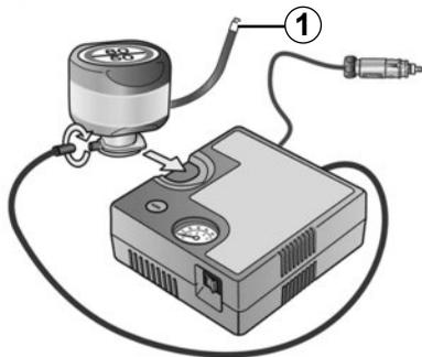
Una vez que el neumático se ha inflado correctamente, retire el kit: desenrosque lentamente la boca de inflado **1** para evitar la proyección de producto y almacene la botella en un envase de plástico para evitar la caída del producto.
