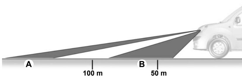
**A** Reglaje incorrecto: la iluminación de su vehículo alcanza demasiada distancia y hay riesgo de deslumbrar. Gire la moleta hacia abajo para disminuir la intensidad del haz de luz.
