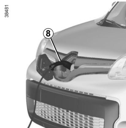
El inicio de la carga se visualiza mediante cinco intermitencias de las luces de precaución. Un mensaje en el cuadro de instrumentos le indica el tiempo de carga restante. No es necesario esperar a llegar a la reserva para recargar el vehículo.
