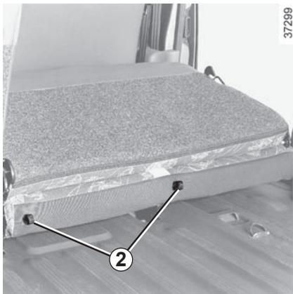
Levante el asiento de la banqueta hacia adelante tirando de las dos anillas **2**, una después de la otra.
