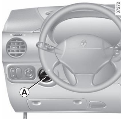
La moleta **A** permite corregir la altura de los faros en función de la carga.
