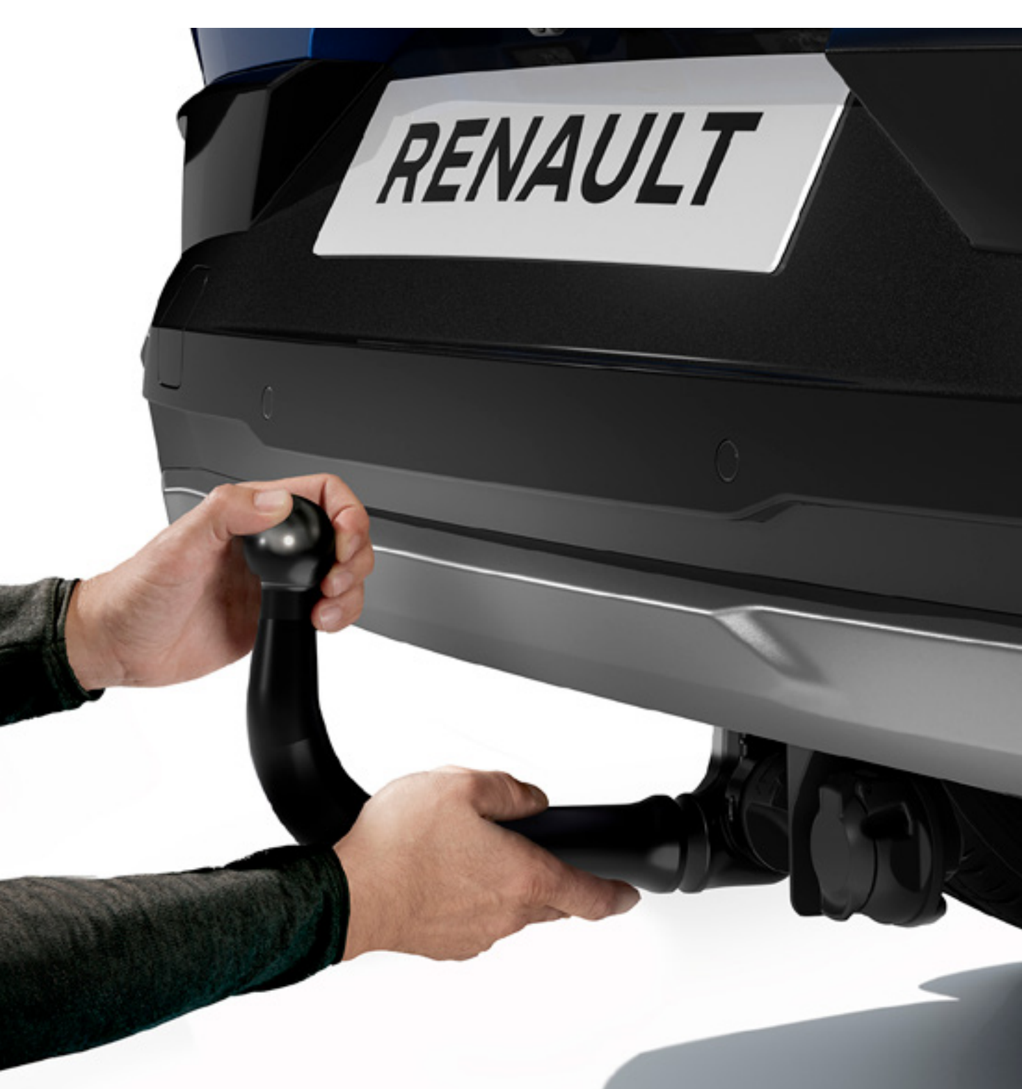
tažné zařízení demontovatelné bez nářadí
