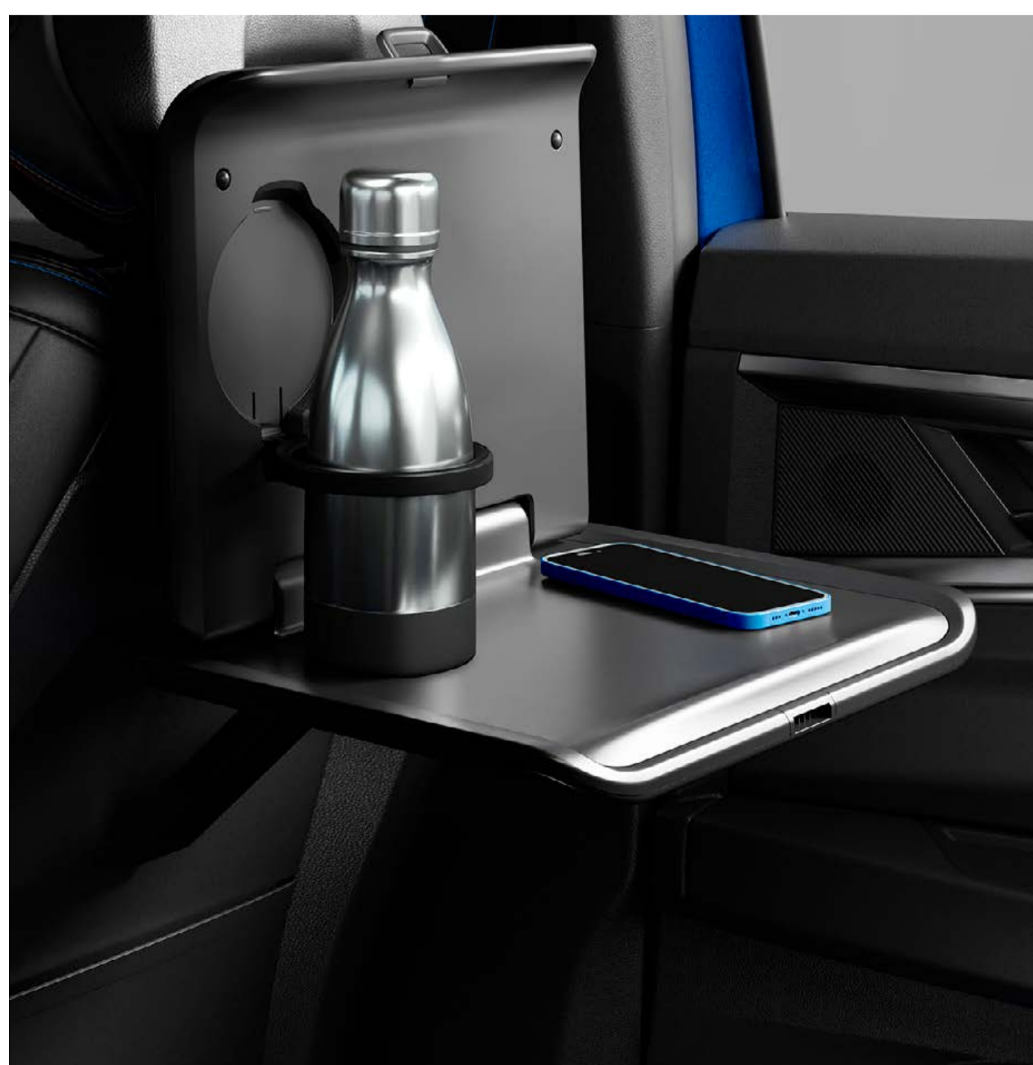
sklopný stolek za přední sedadla (k montáži vyžaduje univerzální nástavec za opěrku hlavy)
