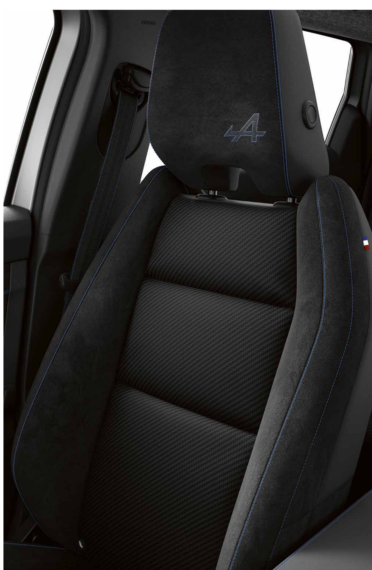
čalounění z recyklované textilie / syntetická kůže s dekorem Alcantara, prošívaní v modré barvě
