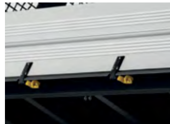
drážka v bočnici a háky pod valníkem pro uchycení plachty či fixačních pásů
