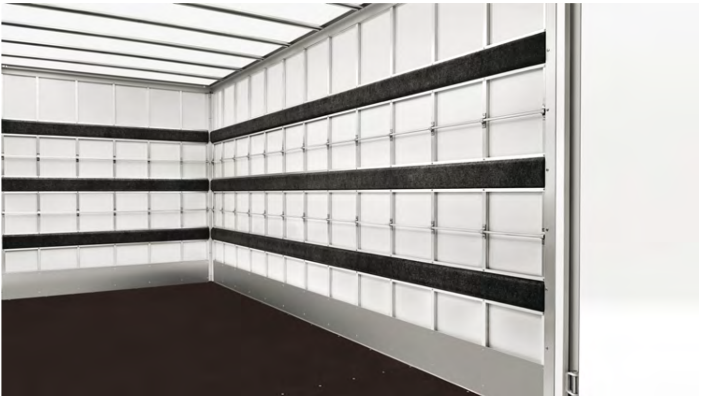
Nákladový prostor s průsvitným stropem a ochrannými bočními lištami.
