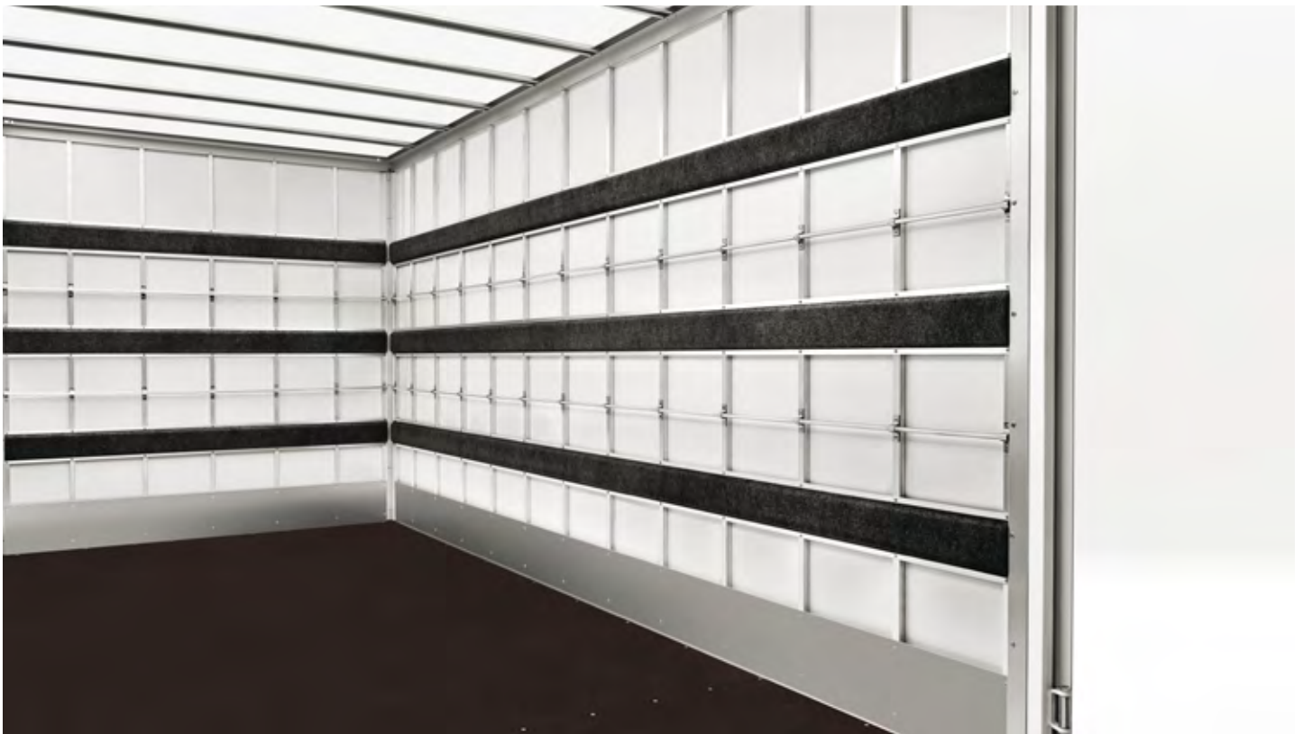
Nákladový prostor s průsvitným stropem a ochrannými bočními lištami.
