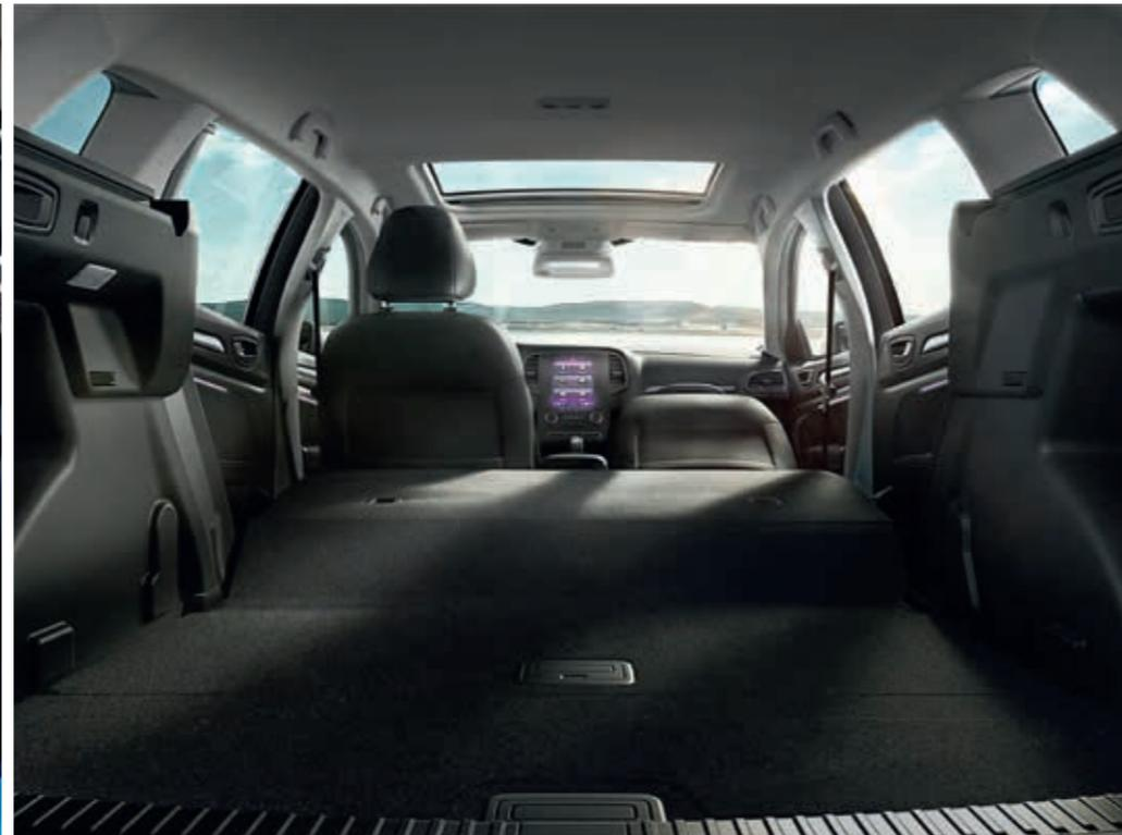
Mit dem **Easy-Break-System** lässt sich die im Verhältnis  $\frac{1}{3}$  zu  $\frac{2}{3}$  geteilte Rücksitzbanklehne durch Betätigung seitlicher Bedienhebel im Kofferraum mit einem Handgriff umklappen.
