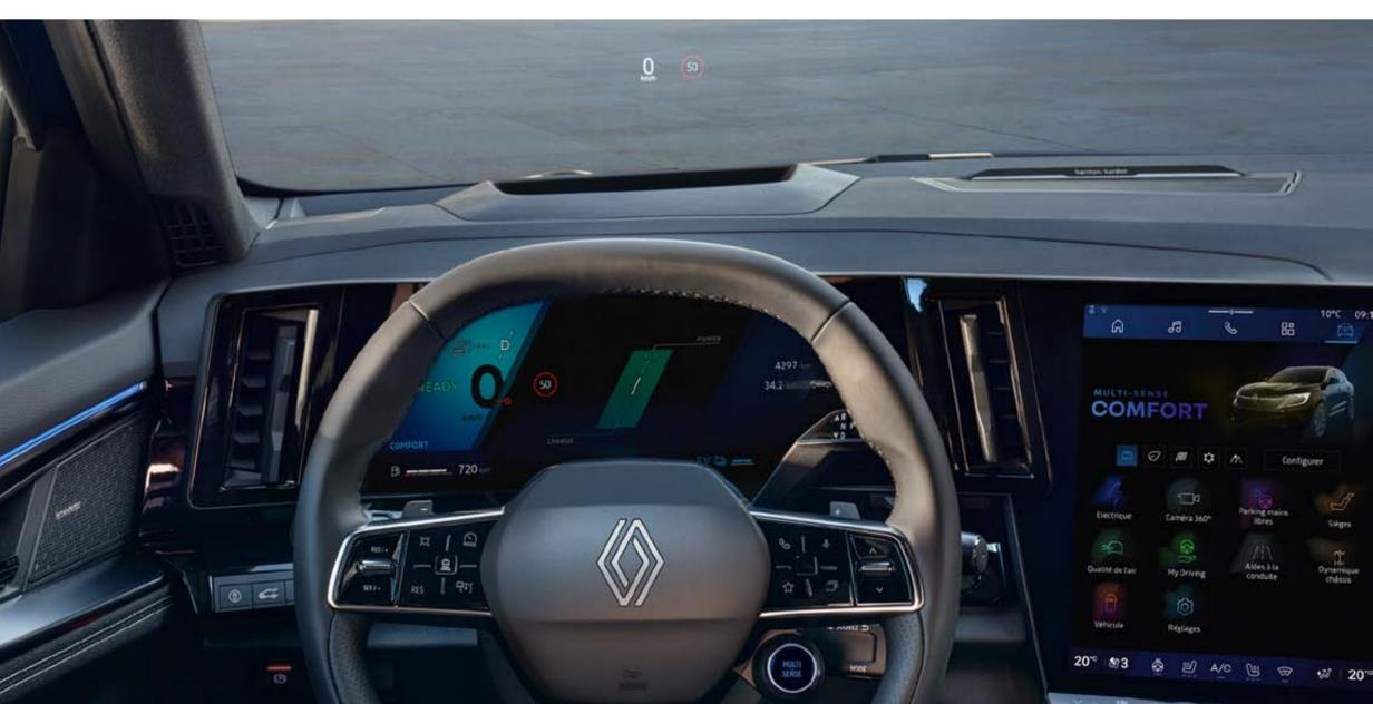
puedes ver la velocidad, los sistemas de ayuda a la conducción y la navegación en el head-up display
