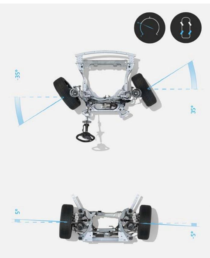
hasta 50 km/h, las ruedas traseras giran en sentido contrario a las delanteras para reducir el radio de giro
