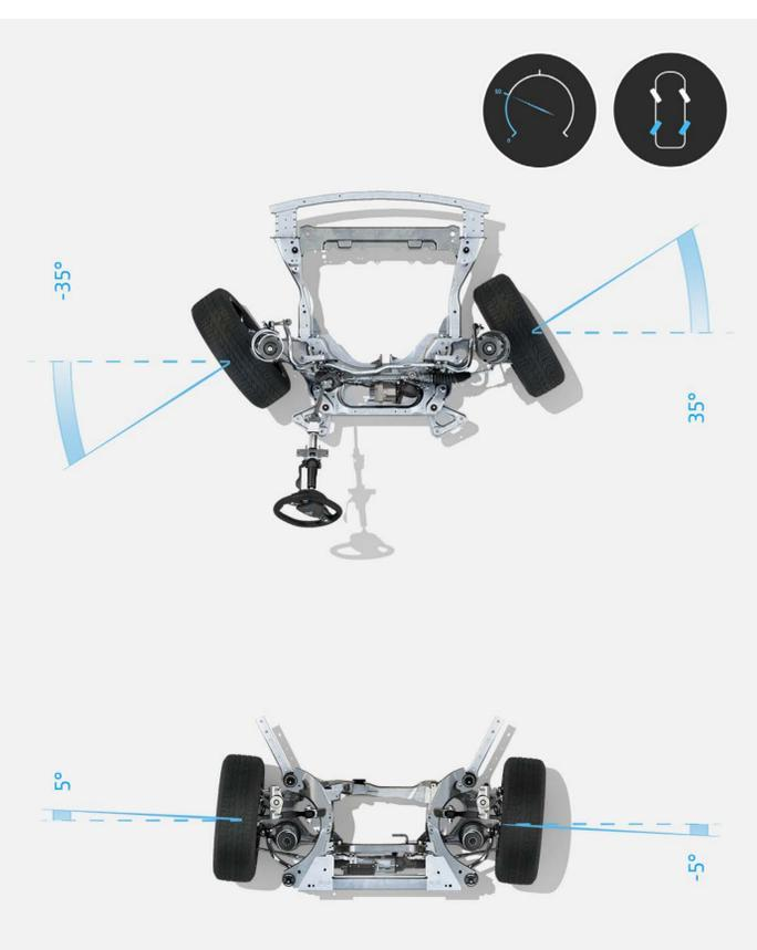
hasta los 50 km/h, las ruedas traseras giran en el sentido opuesto a las delanteras para reducir el diámetro de giro
