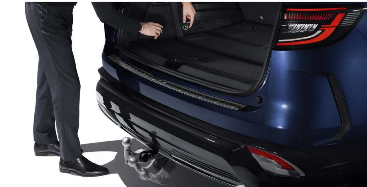
sistema de remolcado retráctil eléctrico 13 pines y cableado de sistema retráctil eléctrico
