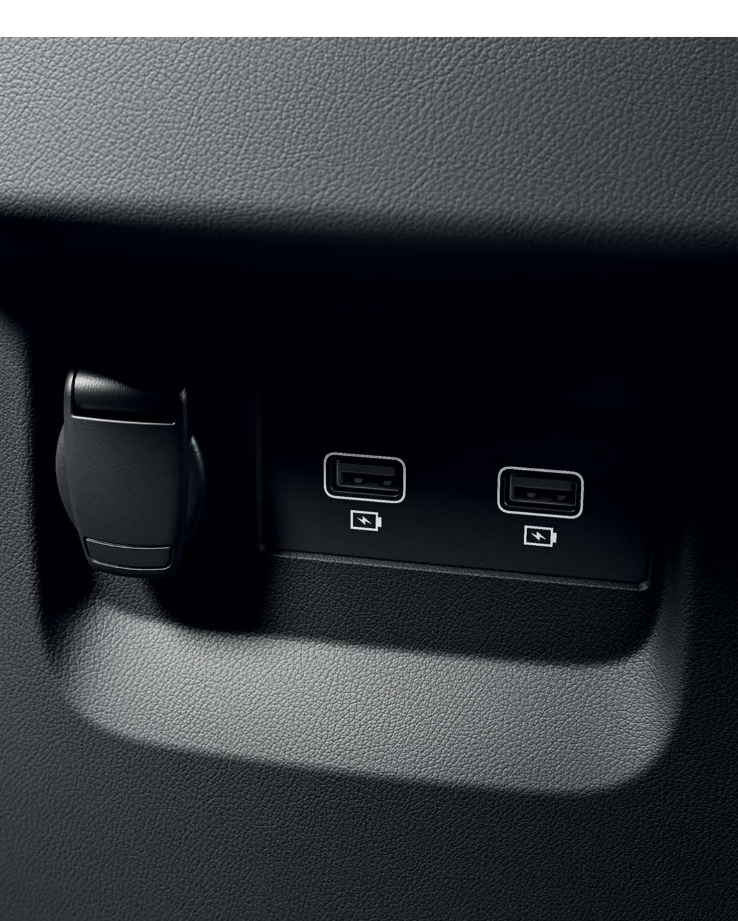
dos puertos USB y una toma de 12 V para los pasajeros de la parte trasera
