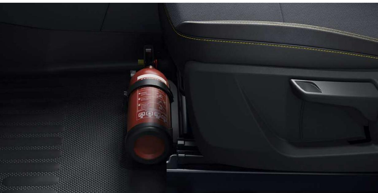
fijación para extintor y extintor de 1kg
