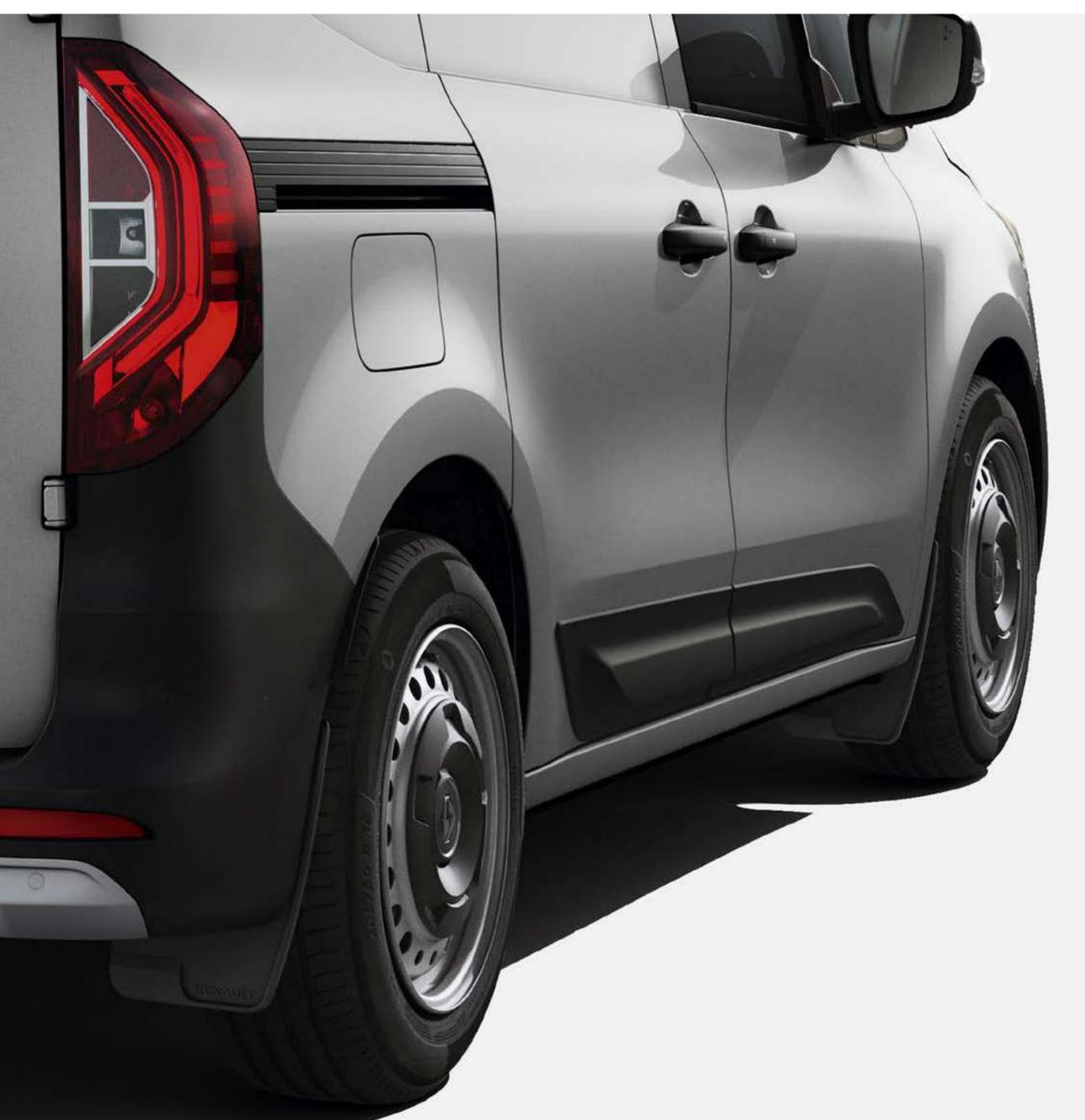
faldillas delanteras y traseras
