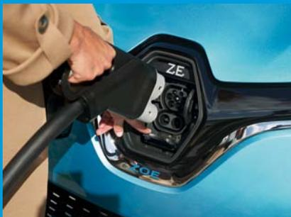
Al conectar tu Nuevo ZOE para cargarlo, la potencia de carga en kW es máxima cuando la batería está totalmente o casi totalmente descargada. La velocidad de carga disminuye a continuación de manera progresiva a medida que su nivel de carga se aproxima al 100%. La potencia de carga que puedes ver depende de la potencia del terminal, la temperatura y el desgaste de la batería.
