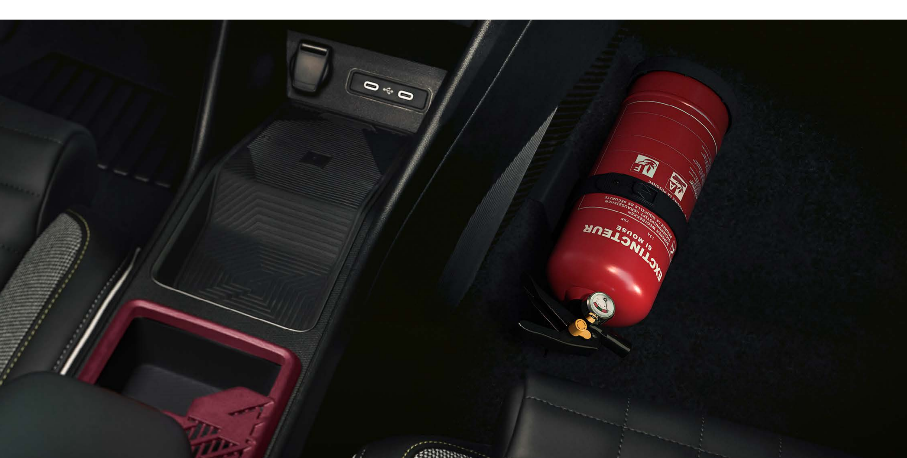
fijación para extintor
