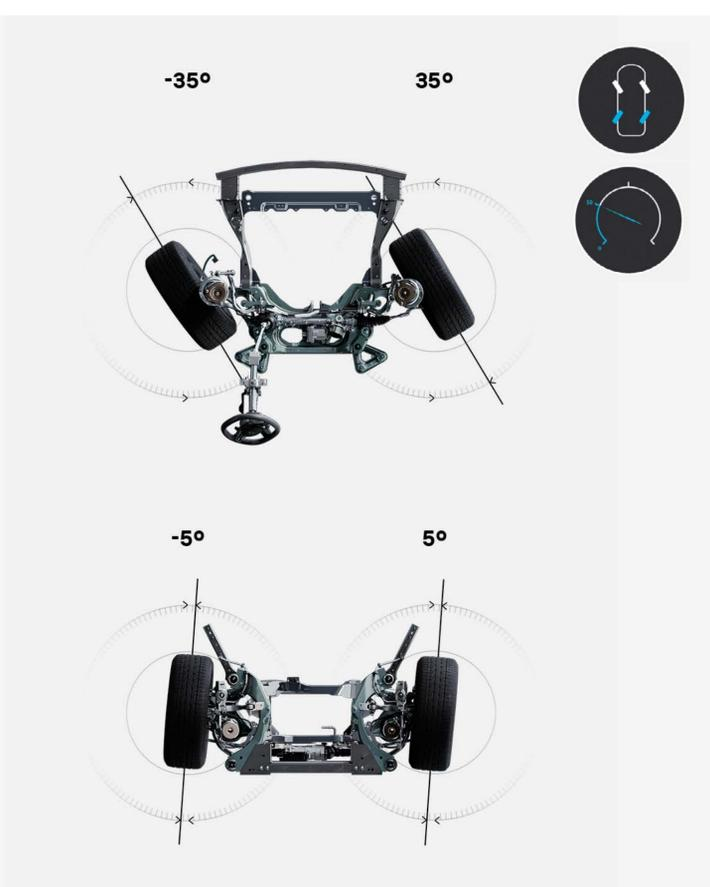
hasta los 50 km/h, las ruedas traseras giran en el sentido opuesto a las delanteras para reducir el diámetro de giro y facilitar las maniobras
