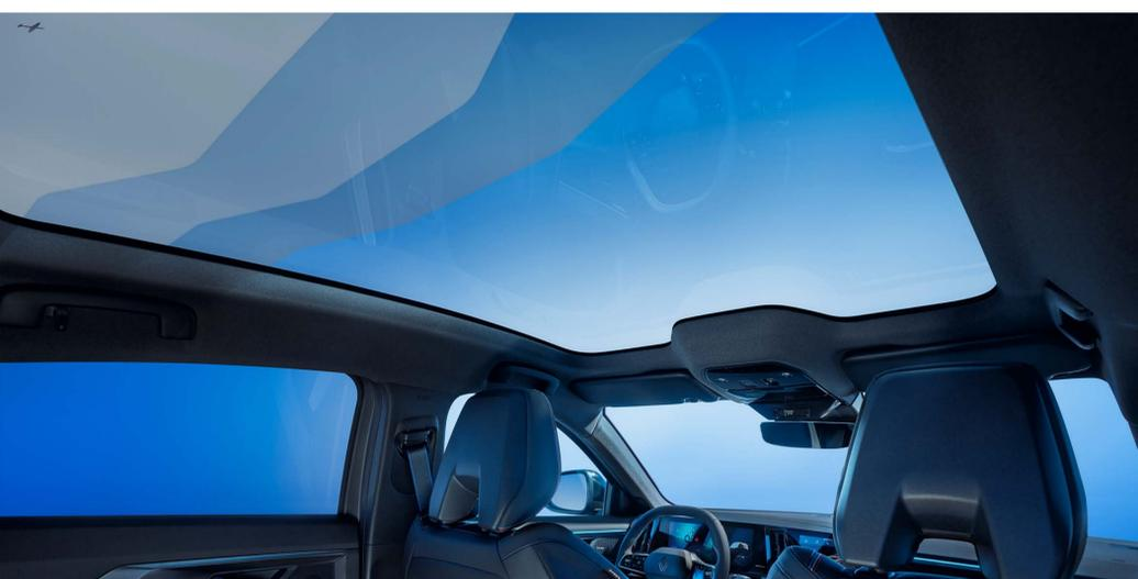
opacificación ajustable en 4 modos (abierto / cerrado) y con 2 zonas (delantera / trasera)
