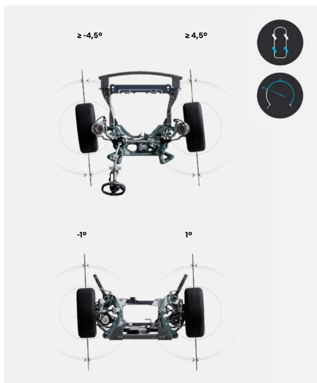
por encima de los 50 km/h, las ruedas traseras giran en el mismo sentido que las delanteras para reforzar la estabilidad y la seguridad en carretera
