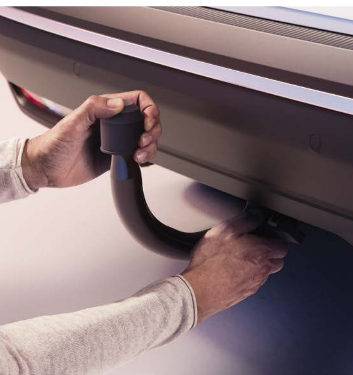
enganche desmontable sin herramientas
