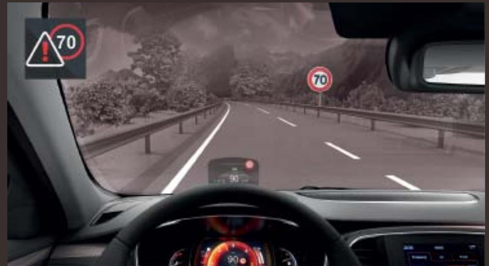
**Alerta de exceso de velocidad con reconocimiento de las señales de tráfico.** El sistema permite adaptar tu conducción en función de los datos de señalización recogidos por la cámara. La alerta visual se produce gracias al Head-up Display.
