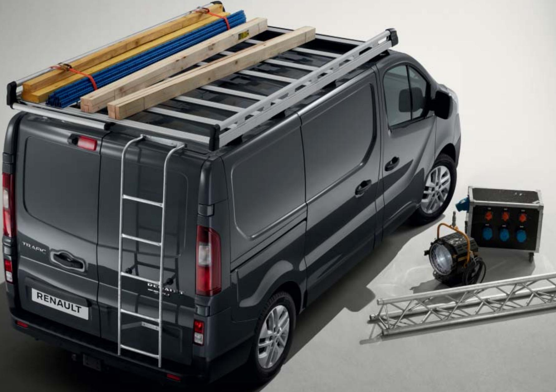
**1. Galería de techo y escalera de techo.** Transporta con seguridad cargas voluminosas en el techo de tu vehículo (hasta 100 kg). Robusta, testada y tratada con anticorrosión, la galería te garantiza una verdadera comodidad de uso. Y para mayor comodidad, la escalera fija en la puerta trasera te permitirá acceder sin esfuerzo a la galería del techo.
