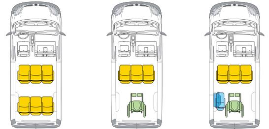
Siège passage de roue incompatible banquette 3<sup>e</sup> rang
