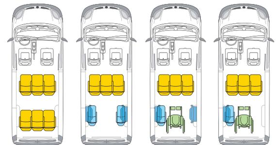
Siège passage de roue incompatible banquette 3<sup>e</sup> rang
