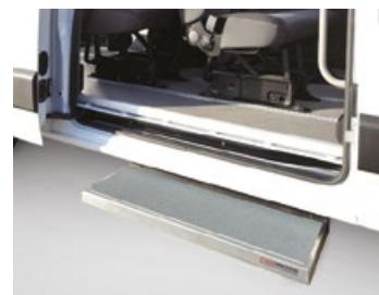
Marchepied latéral Facilite l'accès au véhicule
