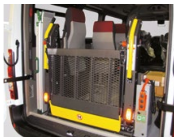
Plateforme élévatrice télécommandée Permet de monter le fauteuil roulant sans effort.
