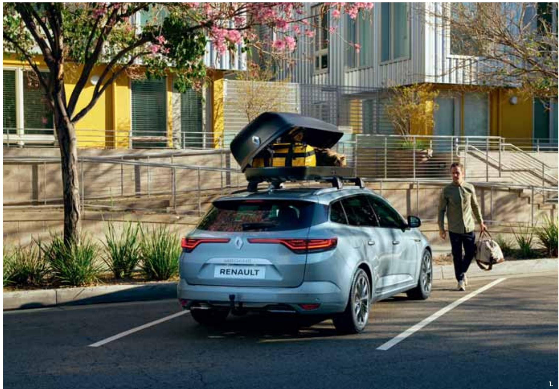
**1. Krovni nosači i krovni kovčevi.** Postavljanjem krovnih nosača QuickFix oslobodit ćete dodatni prostor u svojem Meganeu. Postavljaju se potpuno jednostavno. Na njih možete postaviti nosač skija, nosač bicikala ili krovni kovčeg.
