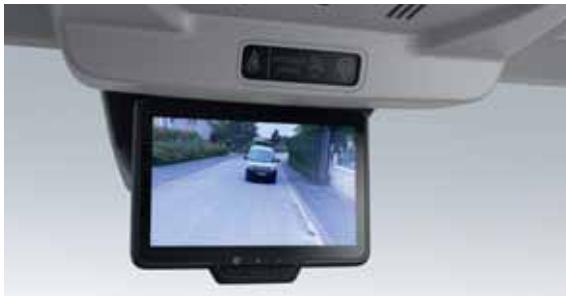
**unutarnje osvrtno ogledalo sa stalnim prikazom.** Na digitalnom zaslonu, ugrađenom na mjesto unutarnjeg osvrtnog ogledala, prikazuje se snimka s kamere ugrađene na stražnji kraj neostakljenog vozila.
