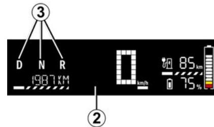
Sul quadro della strumentazione viene visualizzato il simbolo **2** per informare che la posizione **3** è inserita.
