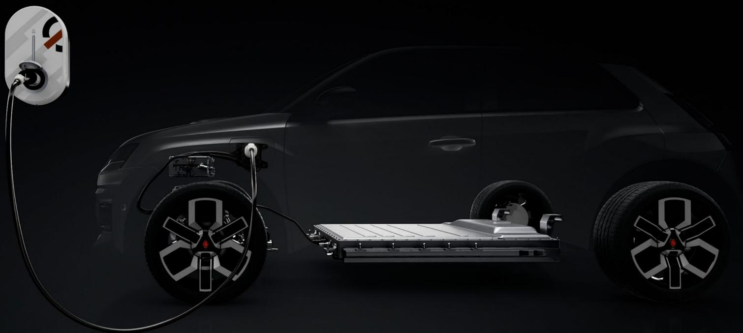
(1) vehicle-to-load, dal veicolo ai dispositivi elettrici. Potenza distribuita ai dispositivi: 3,7 kW
