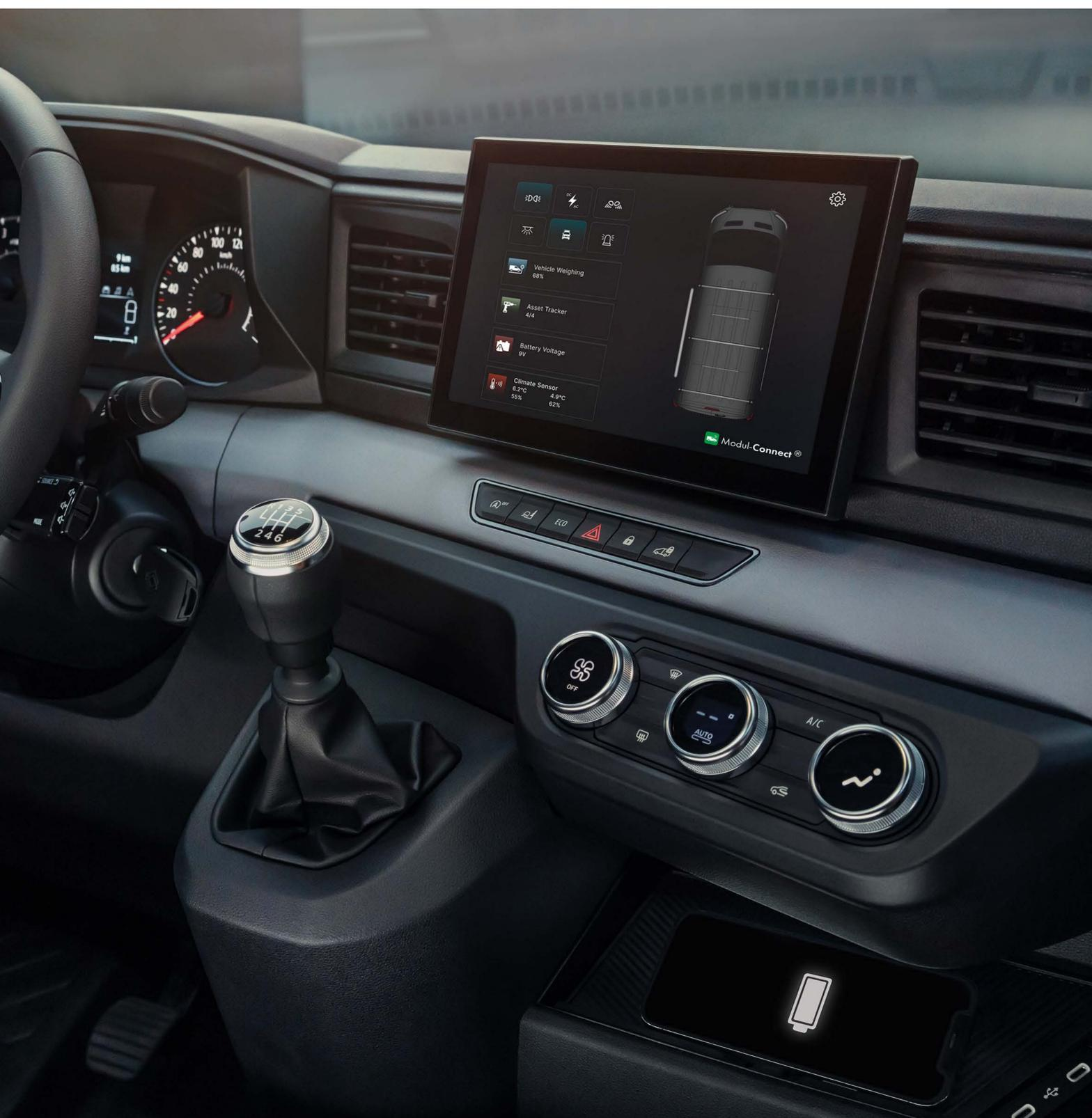
L'opzione Convertor Companion<sup>(1)</sup> è la predisposizione per gli allestitori che consente, attraverso lo sviluppo di app dedicate, il controllo dei device presenti nell'allestimento. Convertor Companion riduce la necessità di installare pulsantiere o schermi aggiuntivi sulla plancia del veicolo garantendo la massima integrazione dell'allestimento. Info tecniche: [www.conversion.renault.com](http://www.conversion.renault.com)
