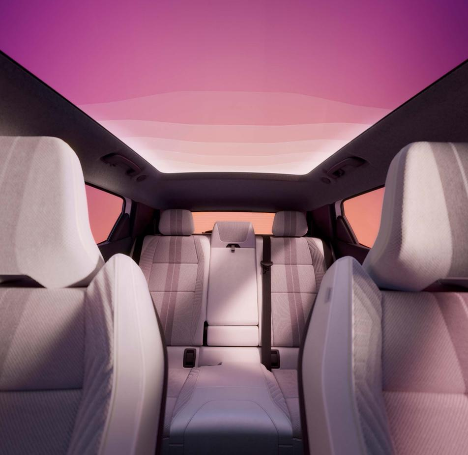
Il sistema Solarbay® si attiva mediante i comandi vocali dell'Assistente Google<sup>(3)</sup> o manualmente tramite il pulsante situato sulla luce di cortesia. Regolabile su 4 diverse modalità di oscurità, assicura luminosità e comfort termico sia d'estate che d'inverno e contribuisce a preservare l'autonomia della batteria riducendo il consumo dell'aria condizionata e del riscaldamento.
