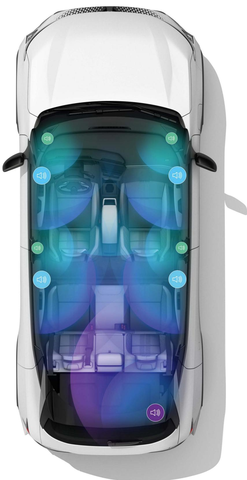
9 altoparlanti per una potenza totale di 410 W: 2 tweeter ai lati del cruscotto, 4 woofer nei pannelli delle porte anteriori e posteriori, 2 tweeter e 1 subwoofer nel bagagliaio
