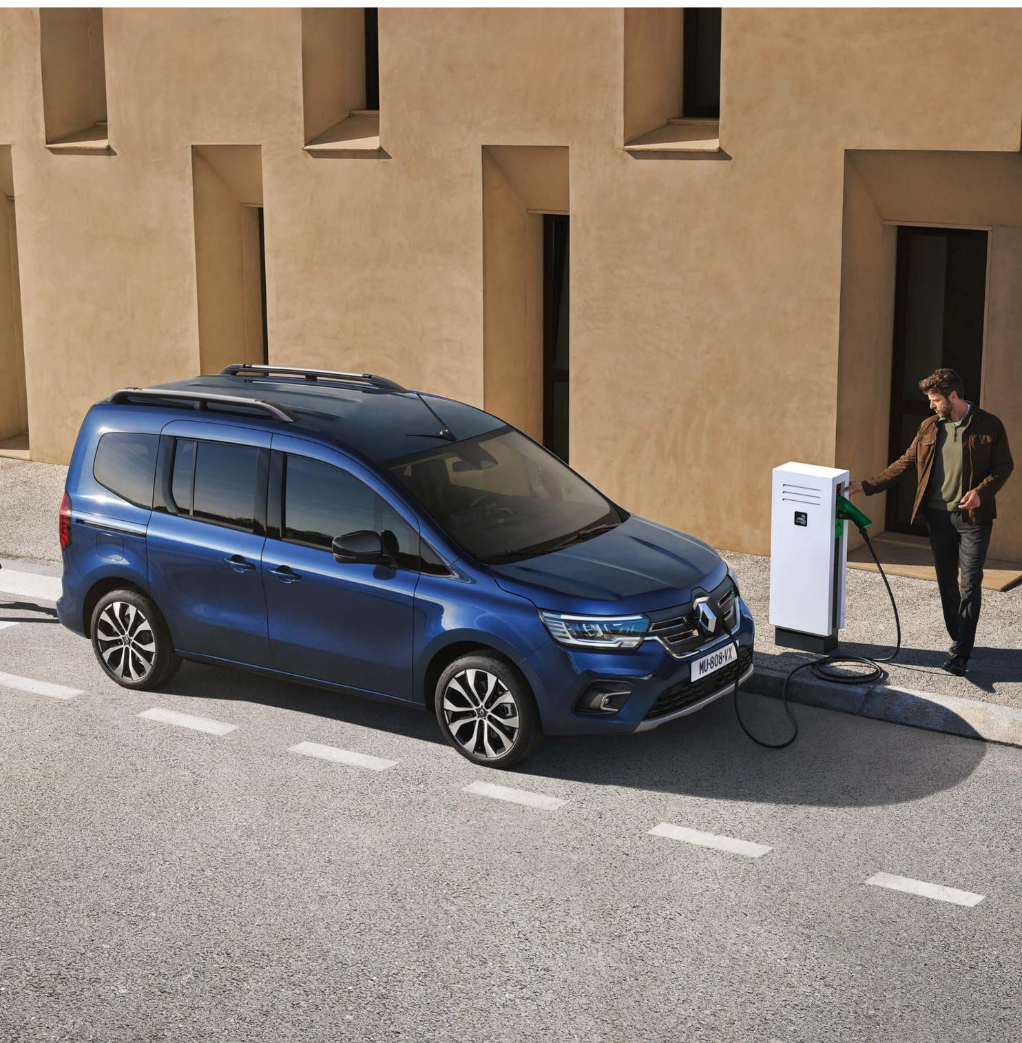
**Renault Kangoo E-Tech 100% electric è dotato di serie di un cavo mode 3 utilizzabile per la ricarica mediante wallbox o presso colonnine di ricarica pubbliche.**
