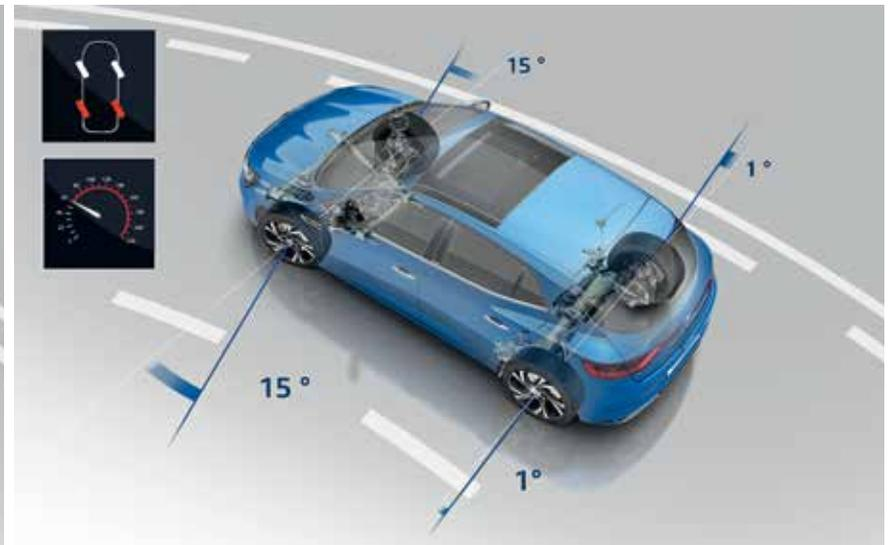
À basse vitesse, le système 4CONTROL braque les roues arrière dans le sens inverse des roues avant. Au-delà de 80 km/h\*, les roues arrière braquent dans le même sens que les roues avant.
