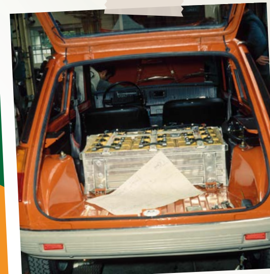
A la place de la banquette se logent 34 batteries.
