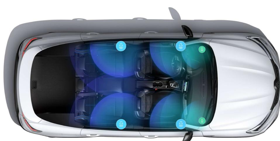
2 tweeters en los laterales y 4 woofers en las puertas delanteras y traseras.
