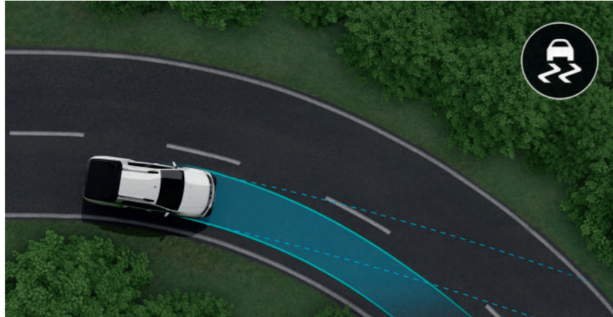
distribución electrónica de frenado (EBD) Corrige automáticamente la trayectoria de tu vehículo para evitar derrapes.
