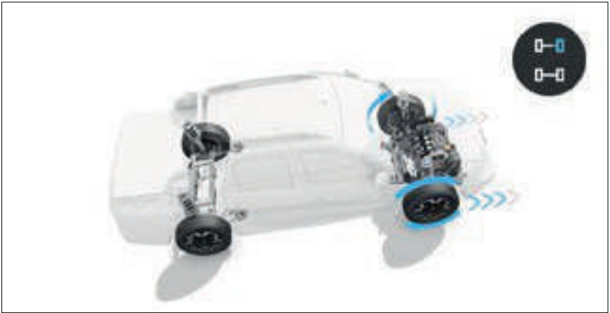
control electrónico de tracción (ASR) Limita el deslizamiento de las ruedas durante el arranque, la aceleración y el frenado.
