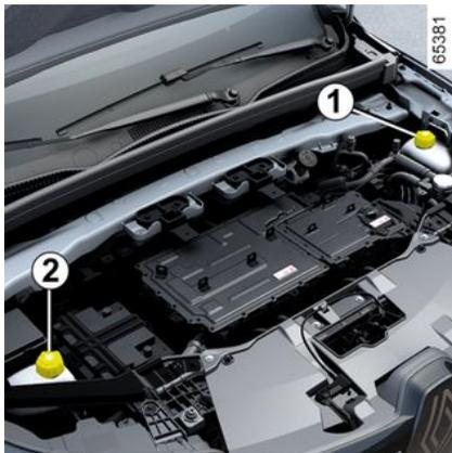
Según el vehículo, la ubicación de los depósitos de líquido de refrigeración puede variar.
