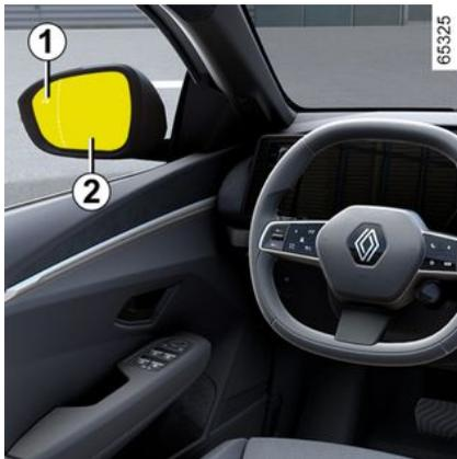
Cuando se abre una puerta, si se detecta la presencia de un objeto en movimiento, se muestra la luz de advertencia **1** en el retrovisor exterior **2** y, según el vehículo, se encienden las luces de ambiente de la puerta delantera.
