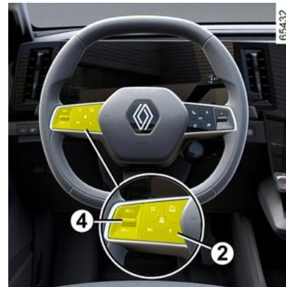
La función limitador de velocidad quedará en stand-by cuando usted pulse el contactor **2** (0).
