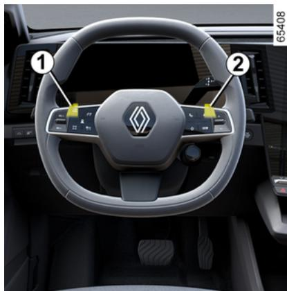
En función del vehículo, se pueden utilizar las levas **1** y **2** para modificar el nivel de frenado regenerativo cuando la palanca de cambios está en posición **D**.
