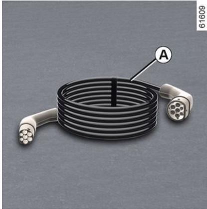
Este cable es específico para su vehículo y se ha diseñado para la conexión a puntos de carga en pared o terminales públicos con el fin de permitir una carga estándar de la batería de tracción.
