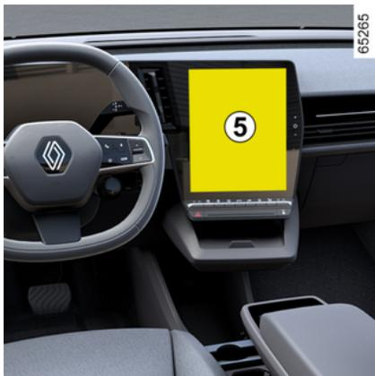
En la pantalla multimedia, cuando se muestra el sistema "cámara de 360°", puede cambiar las vistas (por ejemplo, sustituir la vista trasera por la vista trasera panorámica).
