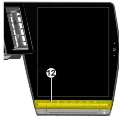
Para controlar el flujo de aire de las rejillas de aire **1** y **3**, presione o eleve el control **12** al nivel deseado.
