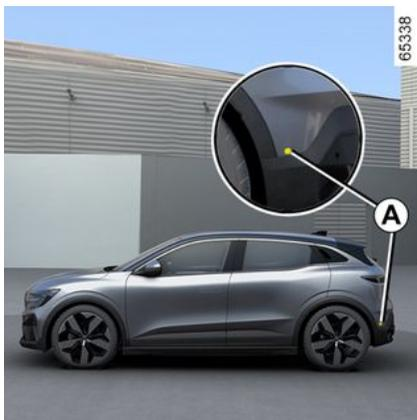
Con la información obtenida por los radares instalados a cada lado del paragolpes trasero (zona **A**), el sistema advierte al conductor cuando otro vehículo aparece en la zona de detección **B**.
