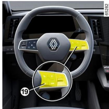
Según el vehículo, al presionar el mando del volante de dirección **19** es posible activar las siguientes funciones de acuerdo con los ajustes de usuario memorizados y que se hayan definido previamente:
