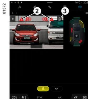
Si el vehículo está equipado con un sistema de remolcado reconocido por el sistema y se acopla un remolque, se desactiva automáticamente el frenado de emergencia activo en marcha atrás y aparece el mensaje "Remolque: sensores de aparcamiento no disponibles" en el cuadro de instrumentos, acompañado del testigo
