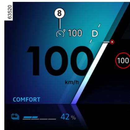
Se muestra el testigo 8 en color gris. Se muestra el mensaje "Speed limiter ready: SET to activate" en el cuadro de instrumentos acompañado de guiones, para indicar que se ha activado el limitador de velocidad y que está a la espera de almacenar una velocidad de limitación.
