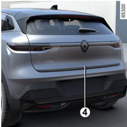
Con la tarjeta en la zona **1** y el vehículo bloqueado, presionar una vez el botón **4** para desbloquearlo completamente.
