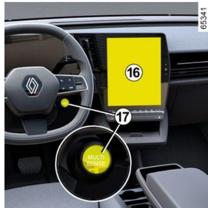
En el menú MULTI-SENSE, accesible desde la pantalla multimedia **16** o al presionar el interruptor **17**, es posible activar el modo ECO, que modifica el nivel de la calefacción y reduce el consumo de combustible del vehículo.
