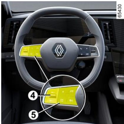
La función limitador de velocidad quedará en stand-by cuando usted pulse el contactor **5** (0).
