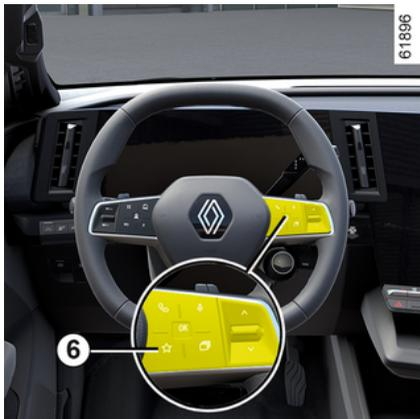
En función del vehículo, al presionar el mando **6** del volante de dirección, es posible activar el volante calefactado según los ajustes de uso que se hayan definido previamente.
