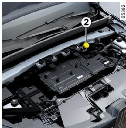
El nivel debe controlarse con el motor apagado y con el vehículo en un suelo horizontal. Debe controlarse a menudo y, en todo caso, cada vez que note cualquier diferencia, por pequeña que sea, de la eficacia del frenado.
