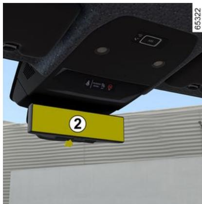
Cuando se pone el contacto, el retrovisor **2** que se encuentra instalado en la consola central del techo, muestra la vista trasera del vehículo que transmite la cámara **1**.
