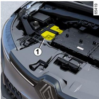
La batería secundaria es de 12 V: suministra la energía necesaria para el funcionamiento del equipo del vehículo (luces, limpiaparabrisas, ventanillas, sistema de audio, etc.) y de determinados sistemas de seguridad, tales como la ayuda al frenado.
