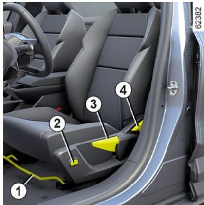
Levantar la empuñadura **1** para desbloquearlo. En la posición elegida, suelte la empuñadura y asegúrese de que queda bien bloqueado.
