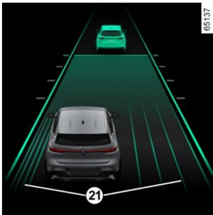
Para activar la posición en el carril, la función "Centrado en el carril" tiene que estar en modo de ajuste, el testigo verde **22** debe aparecer en el cuadro de instrumentos y la velocidad del vehículo ha de ser inferior a 50 km/h.
