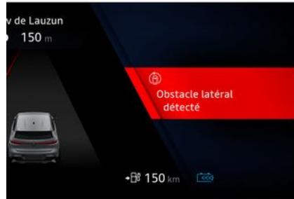
Quando se circula a una velocidad comprendida entre aproximadamente 65 km/h y 180 km/h, al acercarse a una línea (continua o discontinua) y existe riesgo de colisión con un vehículo situado en el ángulo muerto **D** y que se desplaza en la misma dirección que su vehículo o con un vehículo que se aproxima rápidamente por detrás, en un carril adyacente que se encuentra en el área de detección **E**, el sistema:
