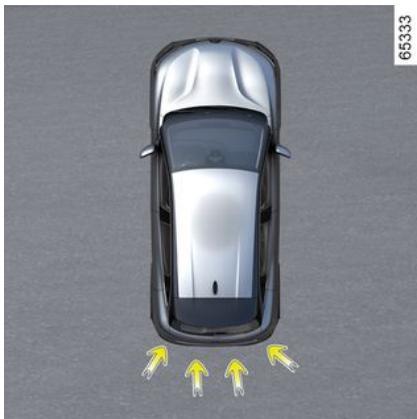
Además de la función "Ayuda al aparcamiento" → 289 y utilizando información procedente de los cuatro sensores centrales colocados en la parte trasera del vehículo, el sistema detecta obstáculos fijos de la zona inmediatamente detrás del vehículo. Si existe un riesgo significativo de colisión, el sistema hace que el vehículo frene automáticamente.
