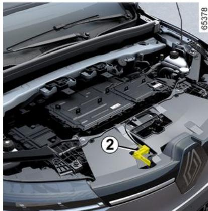
Levantar el capó varios centímetros y empujar la palanca **2** hacia la izquierda.
