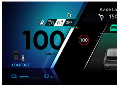
Pulse el interruptor 1 las veces necesarias para seleccionar el limitador de velocidad.
