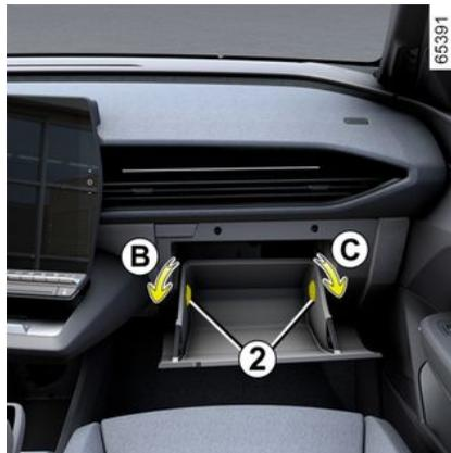
Una vez abierto, girar los tops **2** un cuarto de vuelta (movimientos **B** y **C**) para extraerlos.
