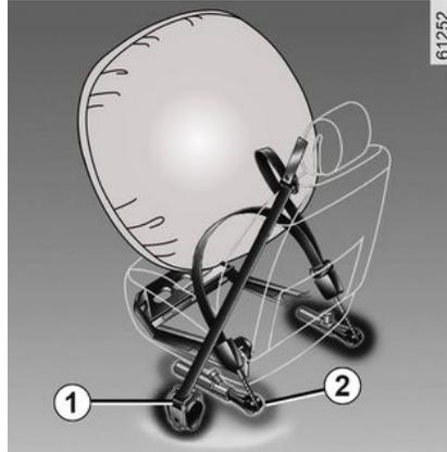
Los pretensores retienen el cinturón de seguridad contra el cuerpo, sujetando al ocupante más firmemente contra el asiento y aumentando de este modo la eficacia del cinturón.
