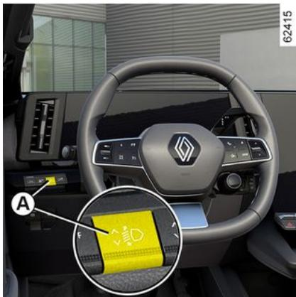
Dependiendo del vehículo, el interruptor **A** puede utilizarse para ajustar la altura de los haces de los faros en función de la carga.
