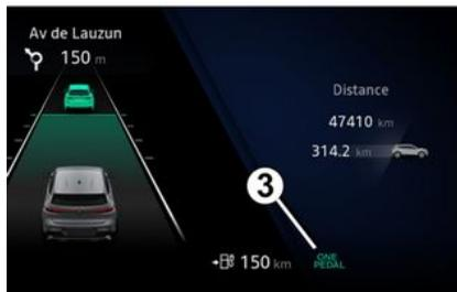
sea necesario hasta que aparezca el mensaje "One Pedal activado". Se visualiza el testigo "One Pedal" **3**, acompañado por un pitido, para confirmar que está activado.
