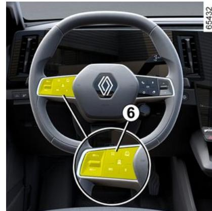
Para adaptar la consigna del limitador de velocidad, del regulador de velocidad o del regulador de velocidad adaptativo al límite de velocidad que se detecte en cada momento, presionar el interruptor 6.
