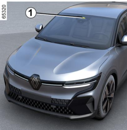
Utilizando la información de la cámara **1**, la función activa una corrección en el sistema de dirección del vehículo cuando se cruza una línea continua o discontinua, o al acercarse a borde de la carretera (mediana, barrera, talud, terraplén, etc.) sin que se activen las luces indicadoras de dirección (intermitentes).
