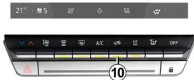
Presionar el botón **10** y se enciende el testigo incorporado. En estas condiciones, el aire se toma del habitáculo y se recircula sin entrada de aire exterior.
