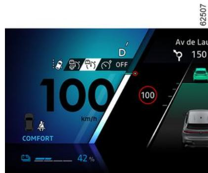
Pulse el interruptor **3** las veces necesarias para seleccionar el regulador de velocidad adaptativo. Se muestra el testigo **10** en color gris. El mensaje "Regulador adaptativo preparado: pulse SET para activar"
