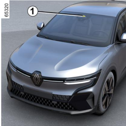
El sistema es capaz de mostrar los límites de velocidad en el cuadro de instrumentos en función de las señales de tráfico que se detecten en los arcones de la carretera.
