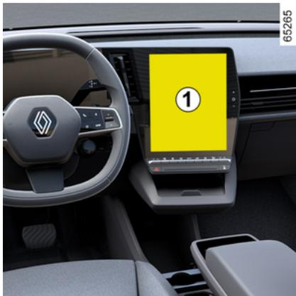
Con el vehículo parado y el motor encendido, desde Mundo "Vehículo" **2**, en la pantalla multimedia **1**, presionar el menú "Eléctrico" **3** y, a continuación, la pestaña "Carga y aire acondicionado" para tener acceso a los ajustes.
