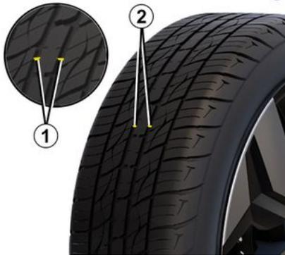
Los neumáticos deben estar en buen estado y sus dibujos deben presentar una profundidad suficiente; los neumáticos homologados por nuestros servicios técnicos van provistos de testigos de desgaste **1** compuestos
