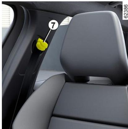
Presionar el botón 7 para regular la altura del cinturón de tal forma que la cinta del hombro quede colocada como se ha indicado anteriormente. Presionar el botón 7 y subir o bajar el cinturón de seguridad. Una vez
