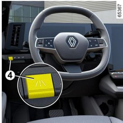
Antes de activar la función, en el valor de World "Vehículo" de la pantalla multimedia 2, pulse el menú "Asistente a la conducción" y, a continuación, el menú "Mantenimiento de carril" y seleccione "Alerta de cambio de carril".
