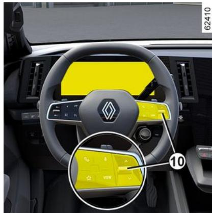
Área de información 7, según el vehículo; navegar con el mando 10 para seleccionar varios widgets del cuadro de instrumentos A:
