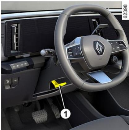
Baje de la palanca **1** y coloque el volante en la posición que desee.
