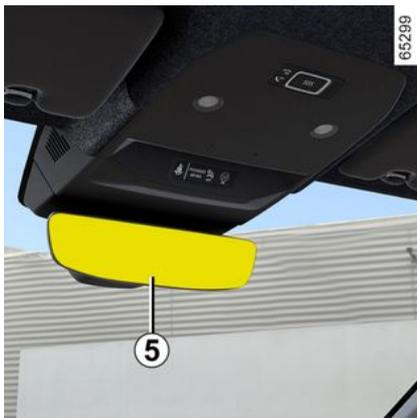
El retrovisor se oscurece automáticamente cuando circula delante de un vehículo con las luces de carretera encendidas o si la luminosidad es muy intensa.
