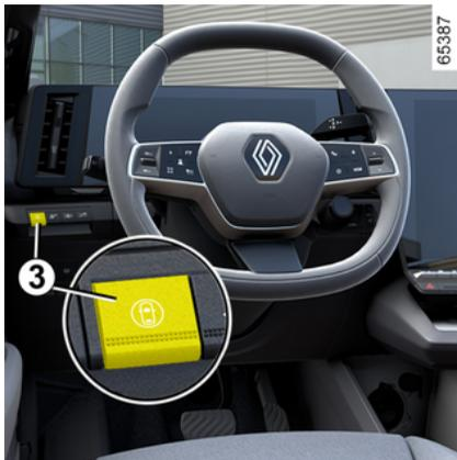
– **Para desactivar la función**, si se ha desactivado del modo "personalizado" de la función "Mi seguridad" → 197 pulse el interruptor **3**
