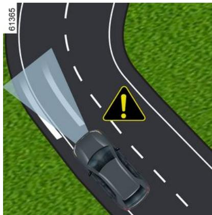
Ante una curva cerrada, y en función de la velocidad del vehículo, las capacidades de retención lateral de la función se ven limitadas y obligan a que el conductor actúe inmediatamente sobre el volante de
