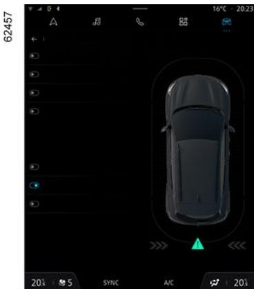
Para activar o desactivar la función mediante la pantalla multimedia **1**, seleccione el mundo "Vehículo" y, a continuación "Ayuda al aparcamiento". Seleccione "Frenado activo de emergencia marcha atrás".
